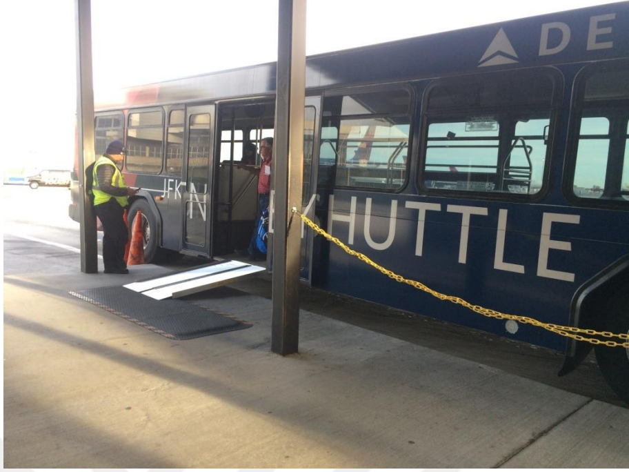
Fotoğraf 72: Servis Aracı Engelli Rampası
