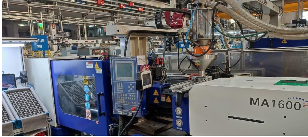
Şekil 2.1. Enjeksiyon kalıplama işleminin gerçekleştirildiği Haitian MA 1600 plastik enjeksiyon makinesine ait fotoğraf
