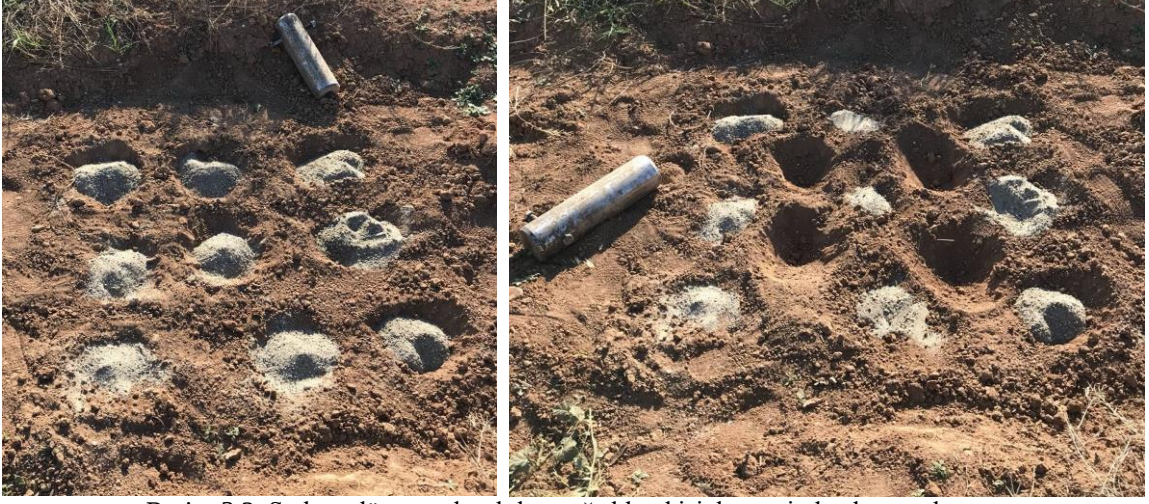
Resim 3.2. Serbest düşmeye bırakılmış ağırlık etkisiyle zeminde oluşan sıkışma
