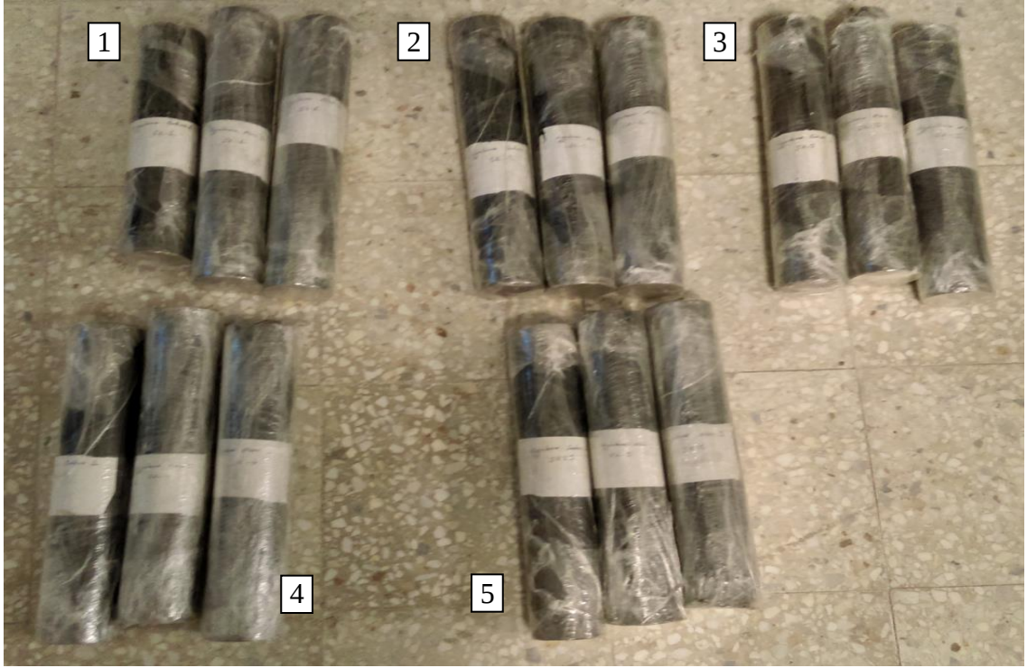
Resim 3.4. Laboratuvar deneyleri yapmak amacıyla Shelby tüpü içerisine alınan numuneler (1: doğal özelliklerdeki numuneler (sol üstte), 2: çimento enjeksiyonu yapılmış (ortada-üstte), 3: kireç enjeksiyonu yapılmış (sağ-üst), 4: epoksi enjeksiyonu yapılmış (sol-alta) ve 5: ağırlık düşürme ile iyileştirilmiş (ortada-alta) zemin örnekleri)
