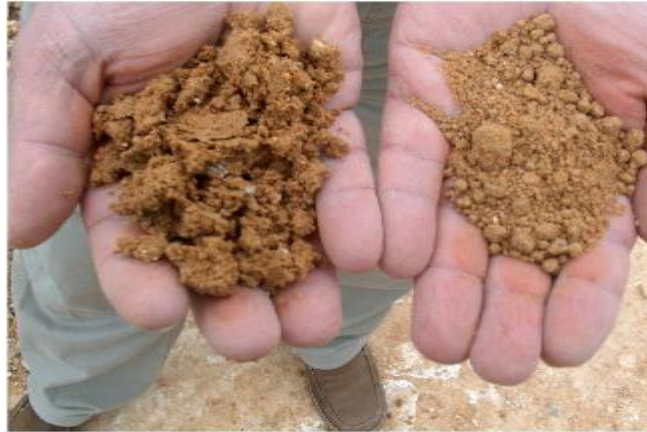
Resim 1.1.'de killi bir zeminin ilk hali ve kireçle stabilize edildikten sonraki hali gösterilmektedir.
