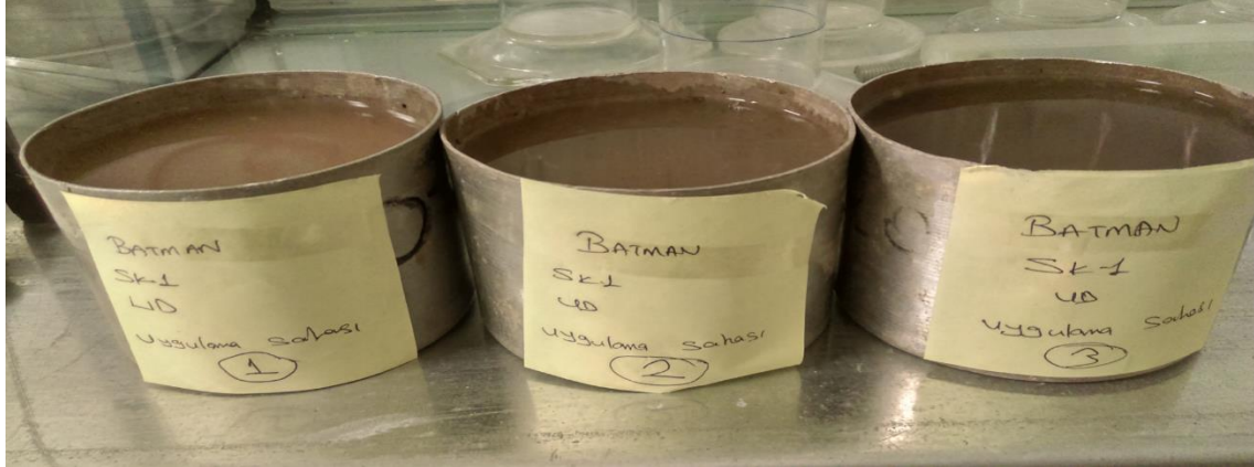
Resim 3.6. Islak elek uygulanacak numuneler
