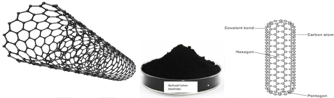
Şekil 2.7. Karbonnanotüpler ve yapısı (Zhang ve diğerleri, 2001)
