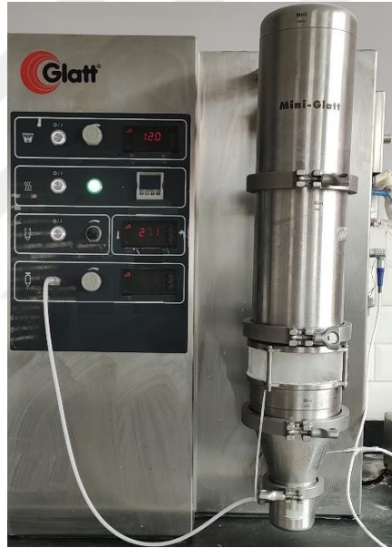
Şekil 3.12. Çalışmada kullanılan laboratuvar ölçekli akışkan yatak sistemi
