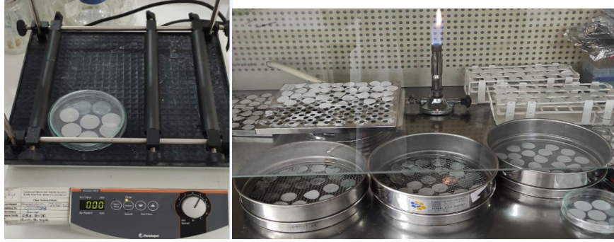
Şekil 3.5. Hutpak ve filtre kağıtların çözeltilerle birleştirilmesi ve kurutulması
