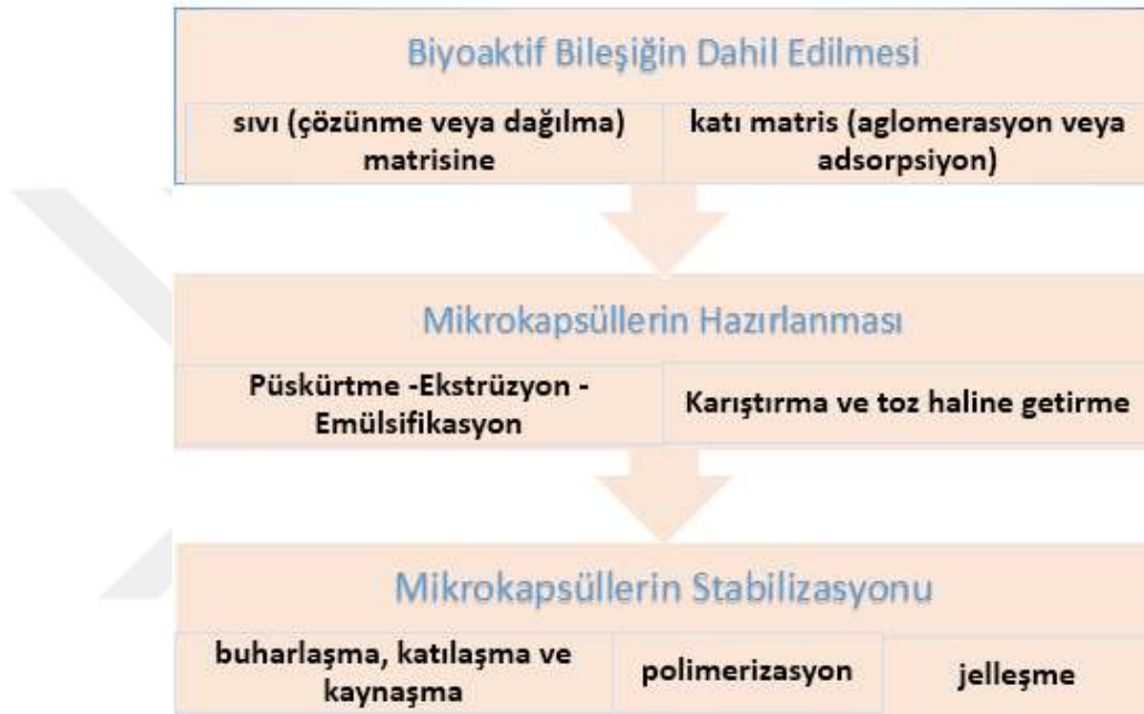
Şekil 2.4. Mikrokapsül üretmek için üç geleneksel adımın şematik gösterimi (Sarao ve Arora, 2017)
