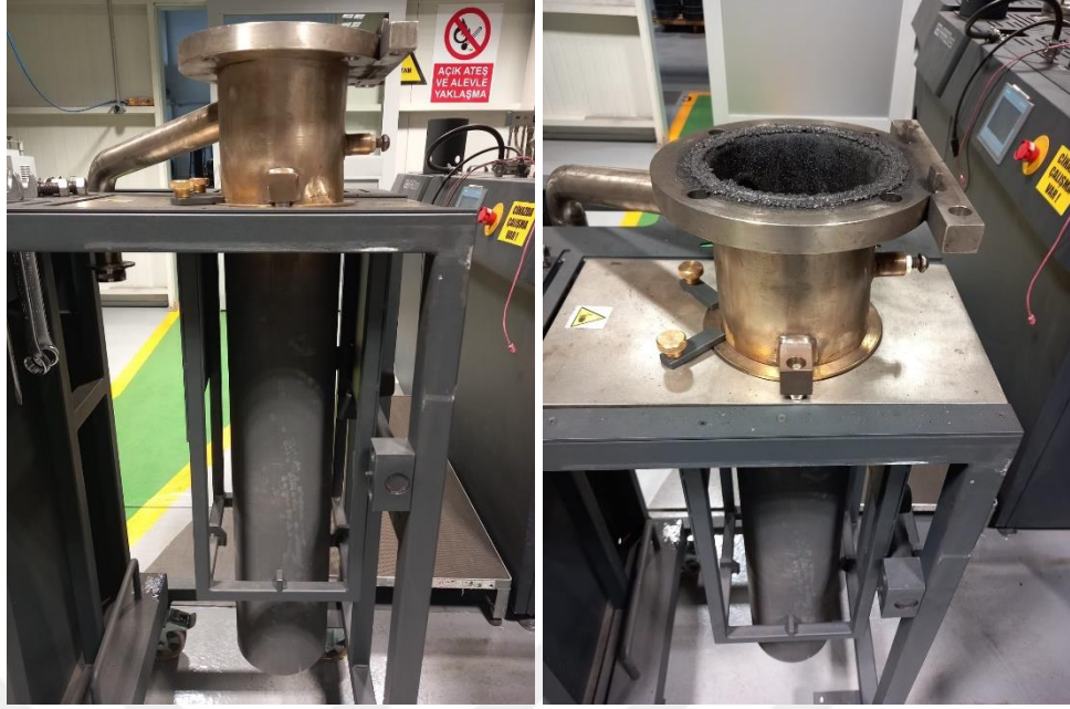
Şekil 6.5. Koklaştırma fırını kömür haznesi
