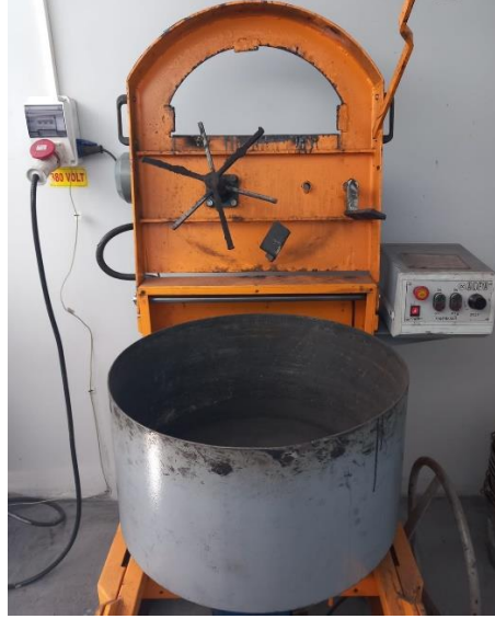
Şekil 6.4. Kömür harmanı karıştırıcısı
