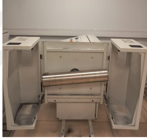
Şekil 6.9. CSR testi tamburu
