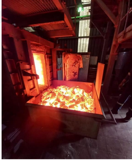
Şekil 6.20. Söndürme arabasına alınan kok
