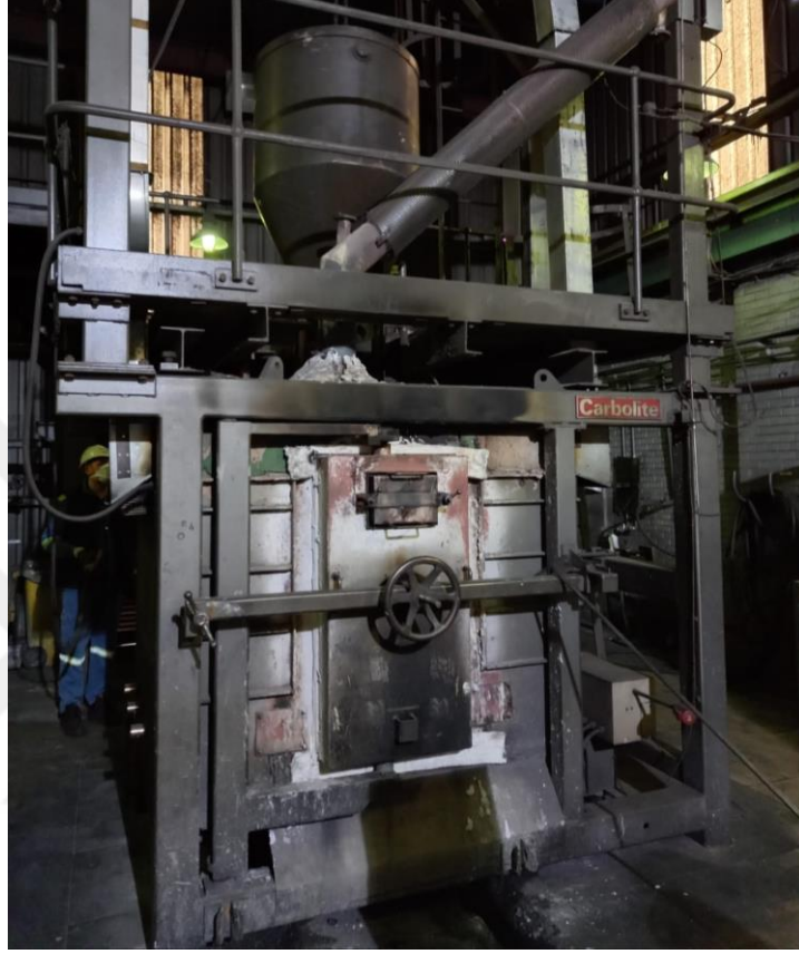
Şekil 6.18. Yarı endüstriyel kok fırını
