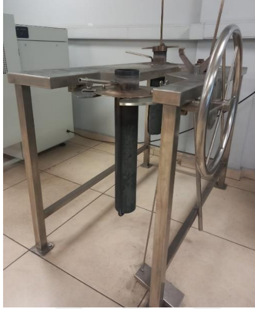
Şekil 6.7. CRI testi fırın haznesi
