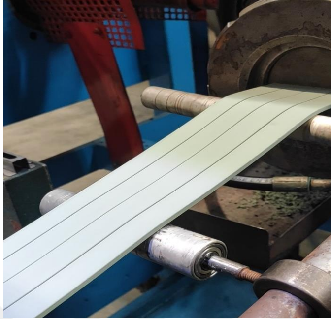
Şekil 3.9. Kauçuk karışımların ekstrüzyon hattında vulkanizasyonu
