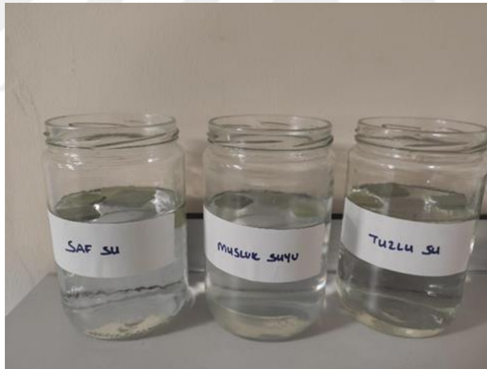
Şekil 3.10. Farklı su örneklerinde test edilen kauçuk numuneler
