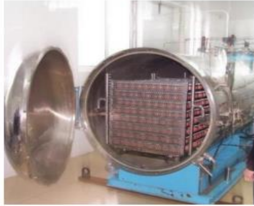
Şekil 2.28. Otoklavda vulkanizasyon (Kervan, 2010).
