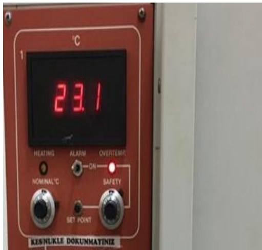
Şekil 9. Xenopus laevis embriyolarının muhafaza edildiği inkübatör (23 °C ±1)
