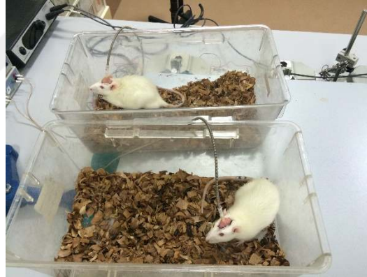
Resim 2. İki aylık WAG/Rij sıçanlarda uzun süreli simultane Video-EEG kaydı
