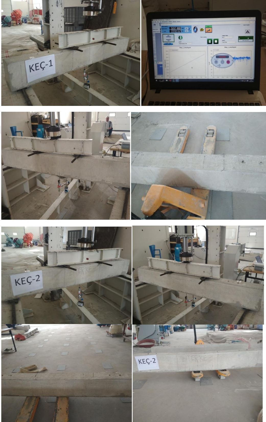
Şekil.4. 18.Çelik Lifli Epoksi Harç ile Güçlendirilmiş Kirişler
