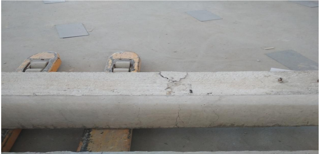
Şekil.4. 14. Elyaf Lifli Epoksi Harç ile Güçlendirilmiş Kirişler
