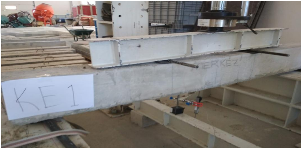
Şekil.4. 28. Güçlendirilmemiş Hasarlı Kiriş KE1 Deney Öncesi Fotoğrafı
