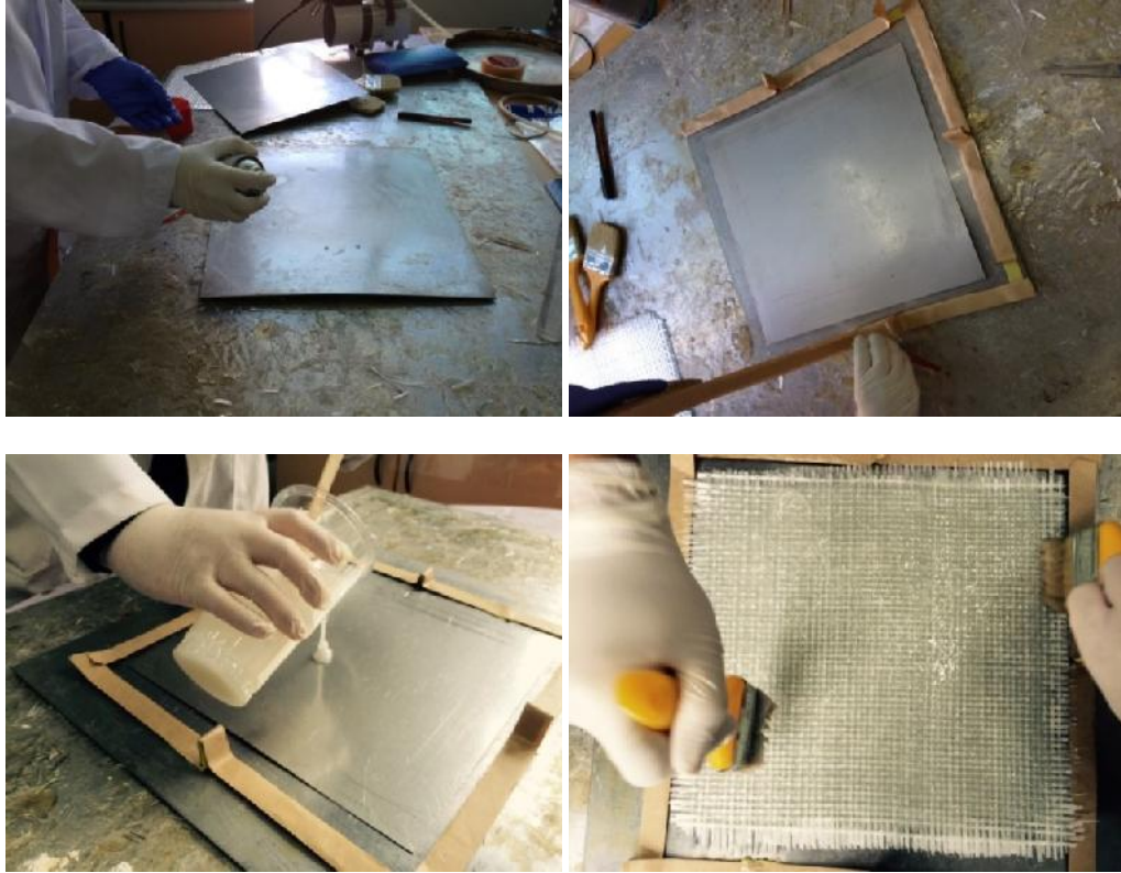
Şekil 4. 2 Vakum torbalama deney görüntüleri
