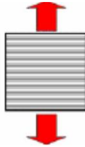
Şekil 2. 6 Eşit gerilme durumunda fiber takviyeli kompozit malzeme
