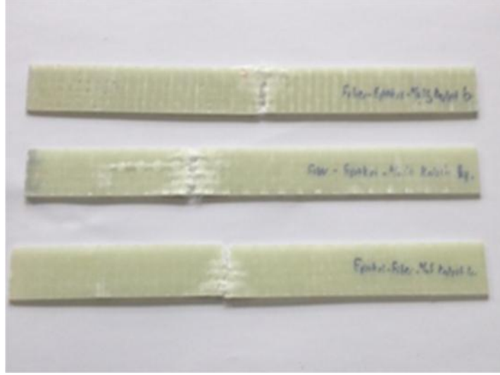
Şekil 5. 3 Çekme deneyi sonrası numuneler
