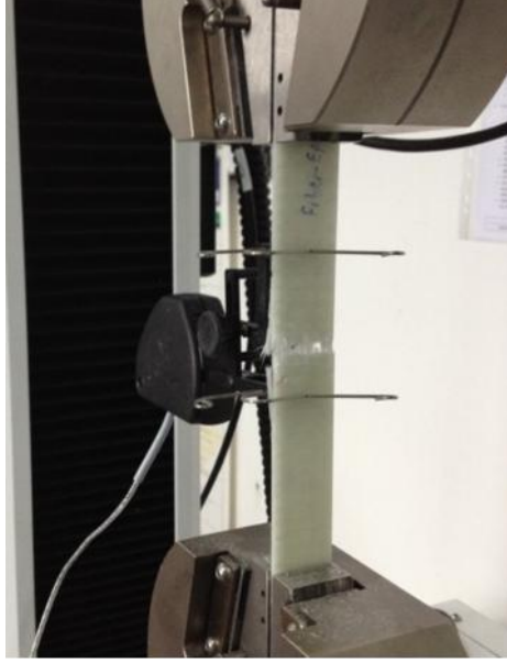
Şekil 4. 8 Çekme deney esnasında numunenin kopma anı
