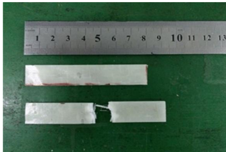
Şekil 5. 6 Eğme deneyi öncesi ve sonrası numune
