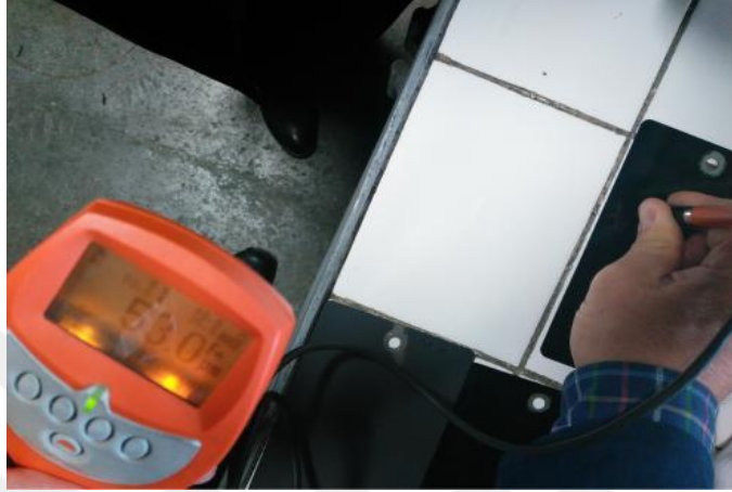
Şekil 3.10. Kaplama kalınlığı ölçümü.
