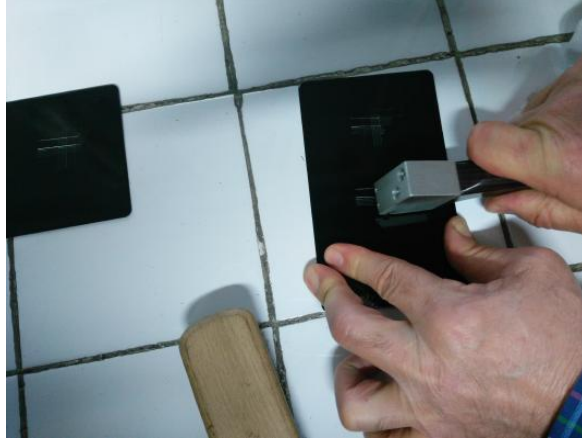
Şekil 3.11. Hazırlanan numunelere kafes çizgi testi uygulanması.
