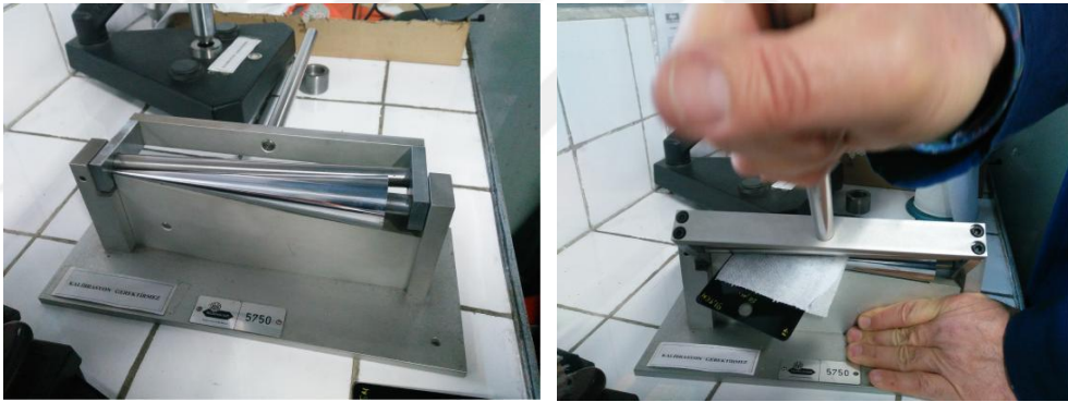
Şekil 3.13. Hazırlanan numunelere konik bükme testinin uygulanması.
