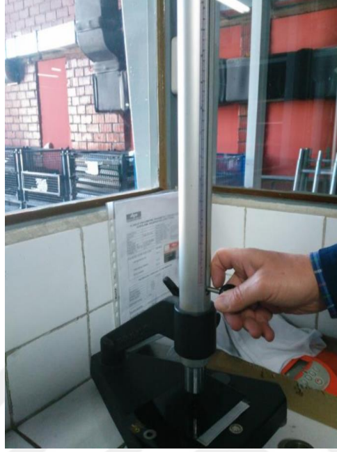
Şekil 3.17. Darbe testinin uygulanması.
