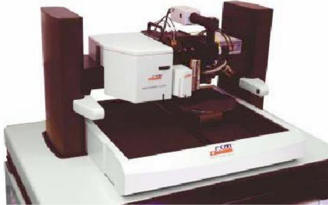
Şekil 3.20. Nanoindentasyon test cihazı.
