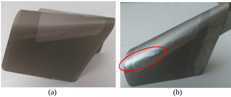
Şekil 3.14. Konik bükme testi uygulanmış (a) saf epoksi ve (b) hibrit katılan numuneler.
