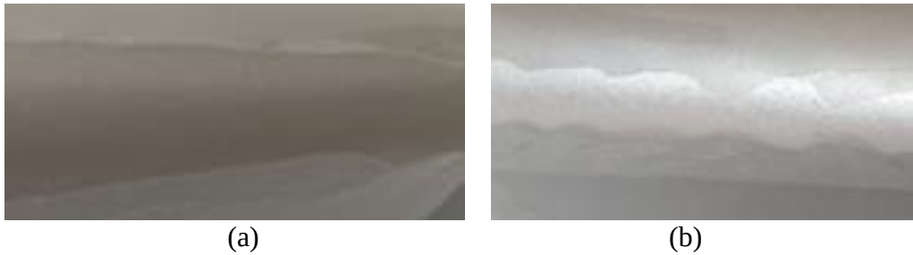
Şekil 4.1. (a) Silika (b) grafen katılan numunelerdeki yırtılma görüntüsü.
