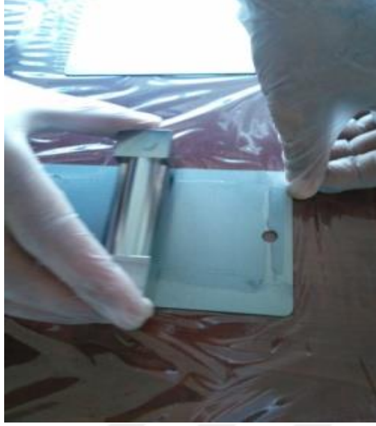
Şekil 3.8. Aplikatör ile kaplama uygulaması.
