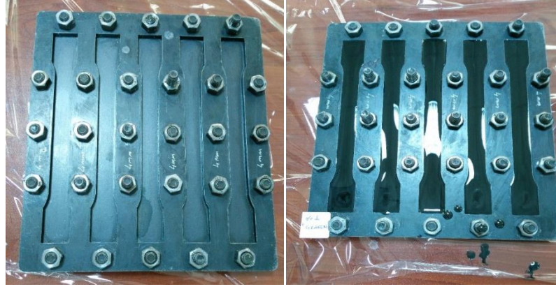
Şekil 3.5. Numune dökülmeden önce ve sonra çekme kalıpları.
