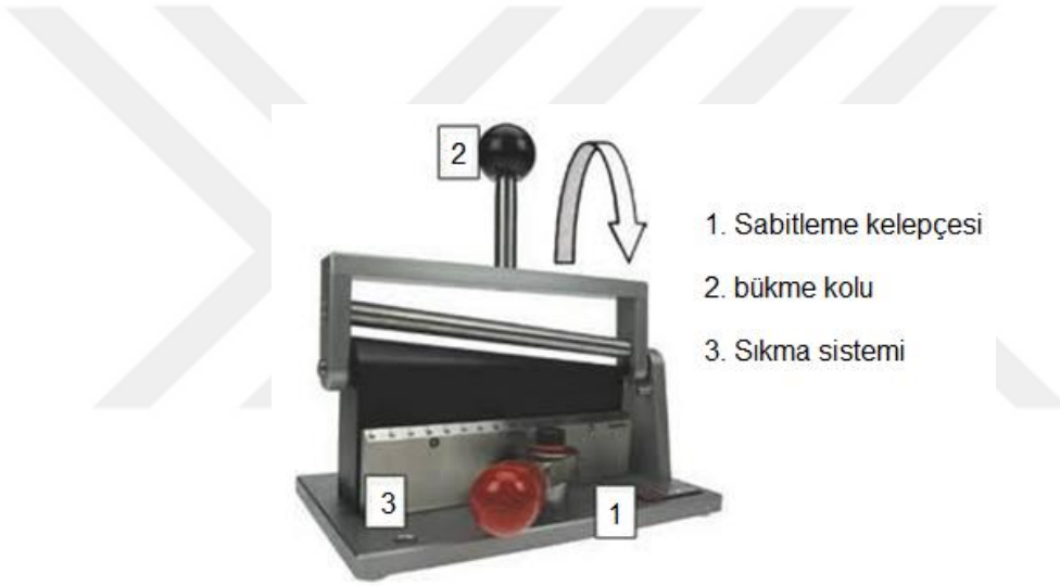
Şekil 2.6. Konik bükme testi.
