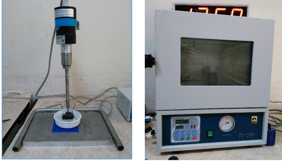
Şekil 3.6. Ultrasonik karıştırıcı ve vakum fırını.
