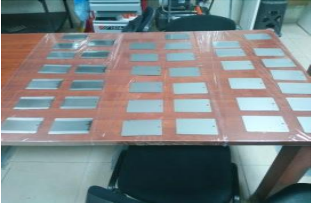
Şekil 3.9. Kaplanmış numuneler (sağdan sola; saf epoksi, silika katılan, GNP katılan epoksi kaplama uygulamaları).
