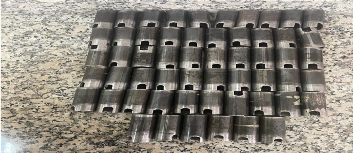
Şekil 3.8. Asetonda bekletilen numunelerin çıkarıldıktan sonra kurutulmaya bırakılması
