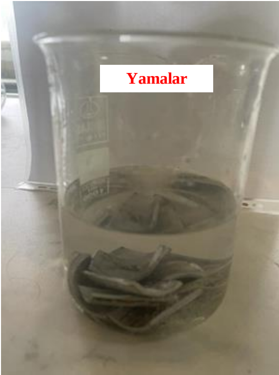
Şekil 3.7. Yamaların ve numunelerin aseton işleminden geçilmesi
