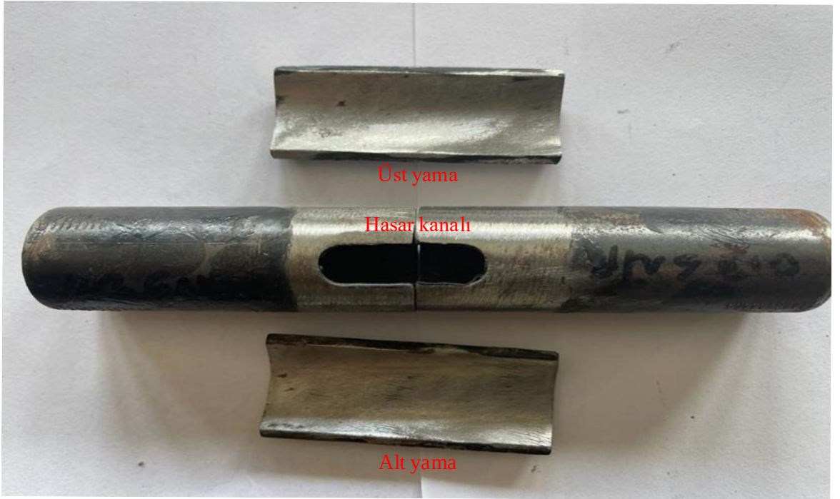
Şekil 3.9. Deneysel çalışma için üretilen yapıştırma ve yama numuneleri
