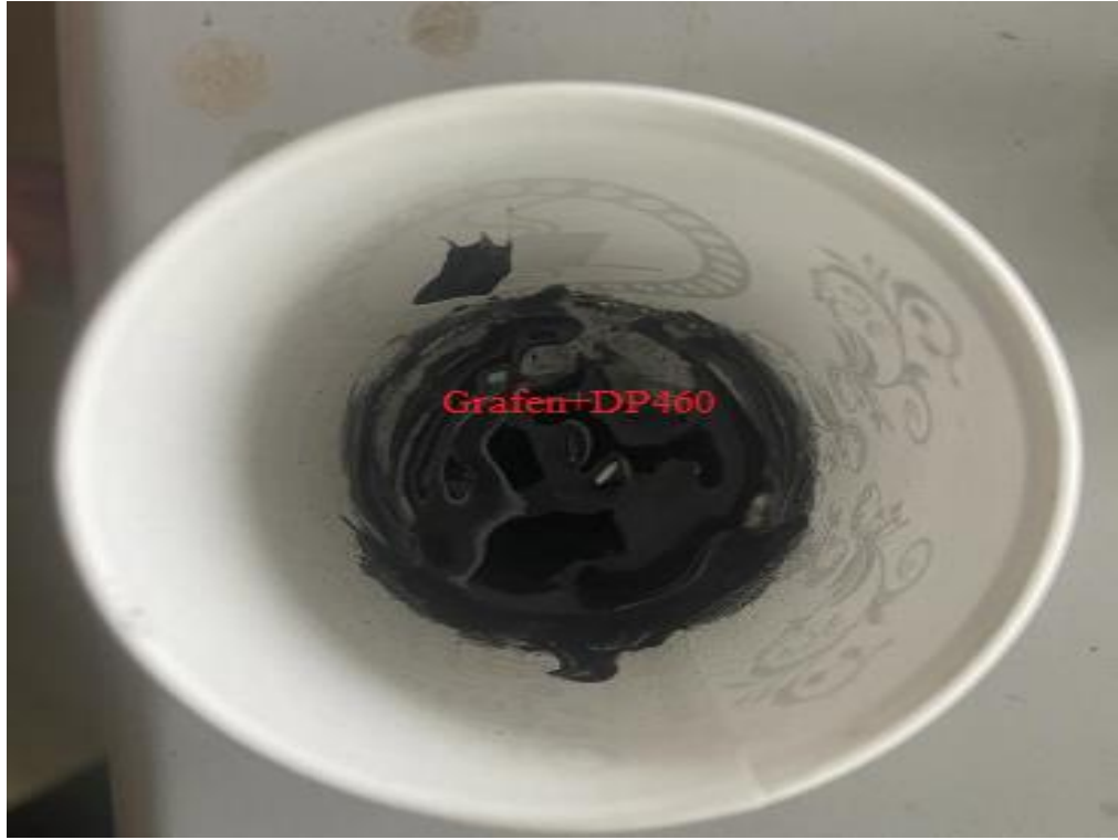
Şekil 3.11. Grafen ve DP400 yapıştırıcının karıştırılması
