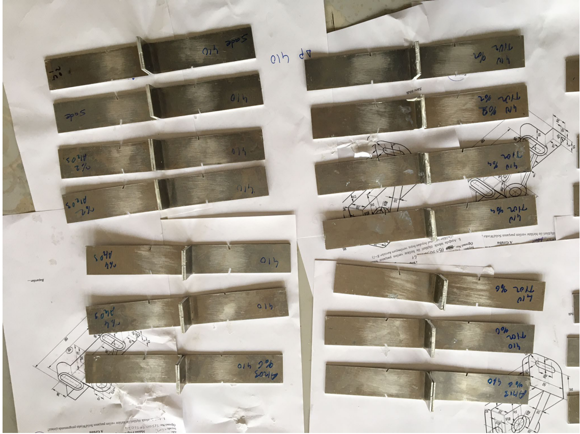
Şekil 3.9 Yapılan yapıştırma işlemi
