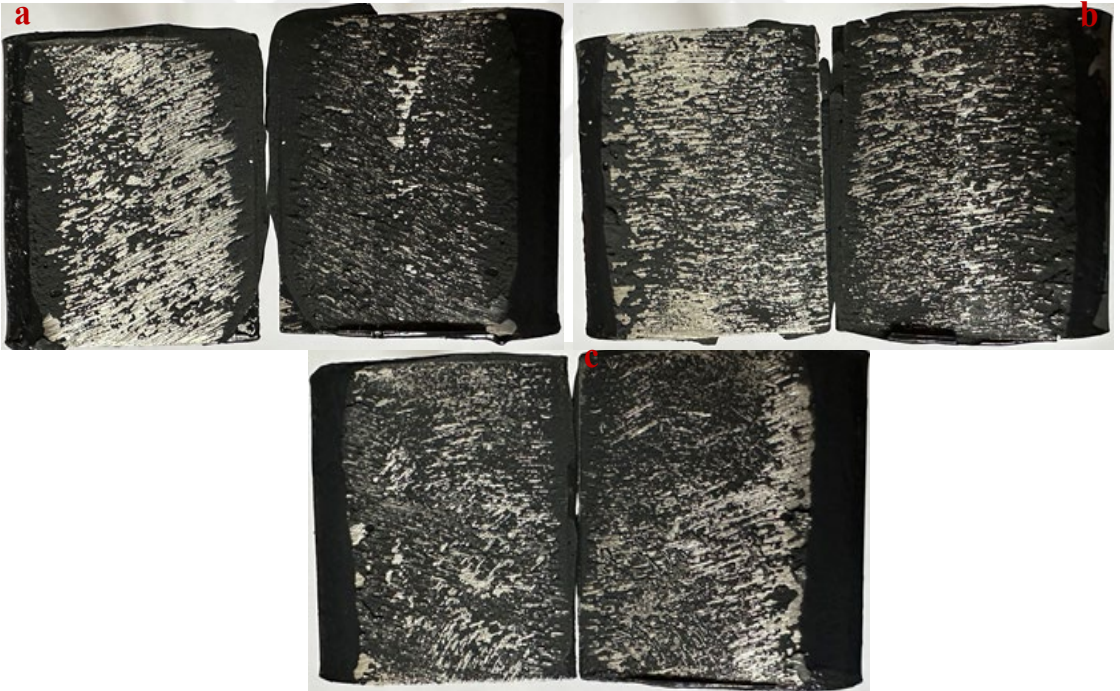
Şekil 4.12. DP490 yapıştırıcısı ve farklı takviye oranlarında TiO_2 ile yapılan yapıştırırmaların çekme kopma sonrası yüzey görüntüleri (a:DP490-%2, b:DP490-%4, c:DP490-%6)
