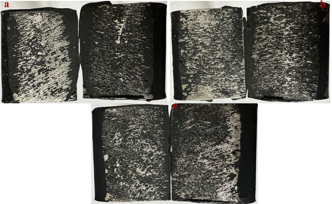
Şekil 4.12. DP490 yapıştırıcısı ve farklı takviye oranlarında \text{TiO}_2 ile yapılan yapıştırırmaların çekme kopma sonrası yüzey görüntüleri (a:DP490-%2, b:DP490-%4, c:DP490-%6)
