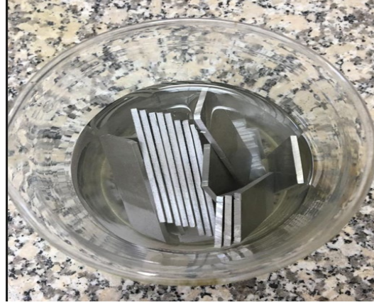
Şekil 3.4. AA5754 Alüminyum alaşımının asetona daldırılması
