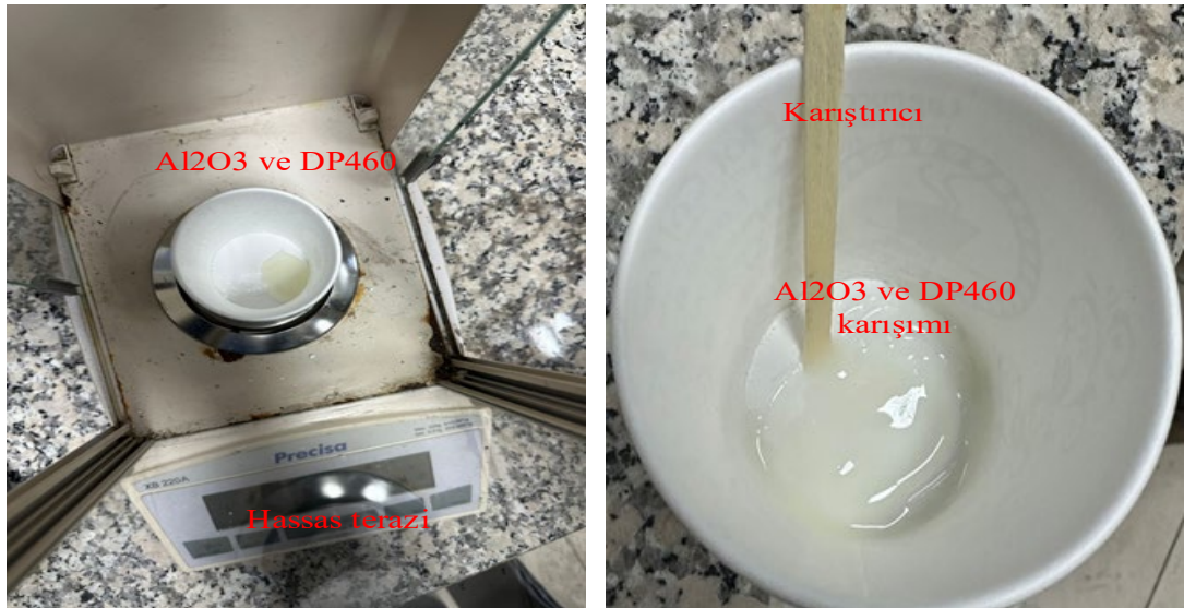
Şekil 3.7. Partiküllerin ve DP460 yapıştırıcı karışımların hassas terazide ölçümleri
