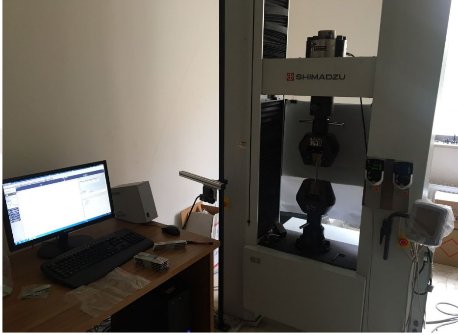
Şekil 3.11. Çekme deneylerin yapıldığı çekme deney cihazı
