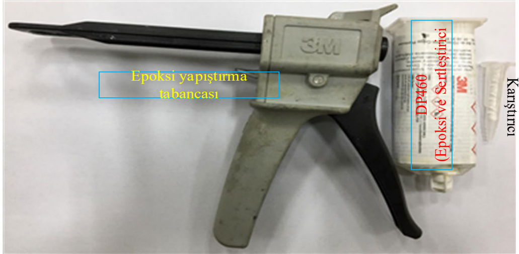
Şekil 3.6. Yapıştırma işleminde kullanılan tabanca, karıştırıcı nozel ve DP460 yapıştırıcısı
