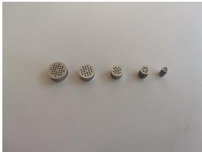
Fotoğraf 3.10. Farklı Ölçülerde Alüminyum Nozullar
