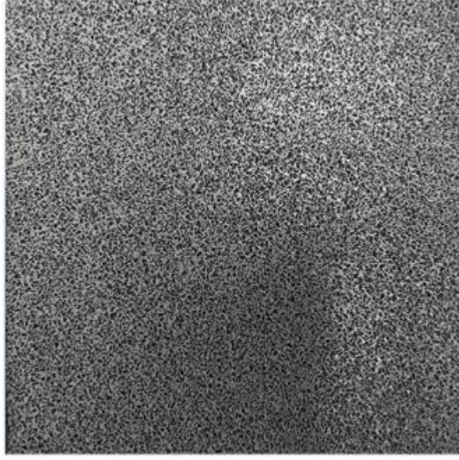
Şekil 2.6. Vakumlama Kalıplarda Kullanılan Gözenekli Alüminyum (Ercil, 2020)
