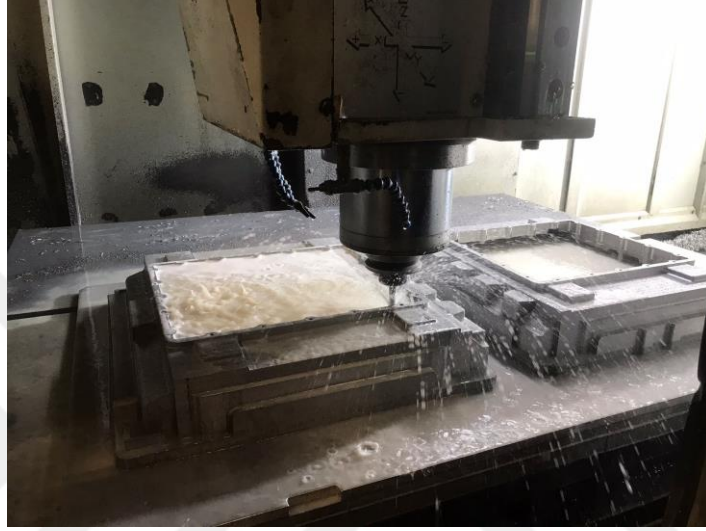
Fotoğraf 3.15. Erkek Göz İmalatında Kullanılan CNC Freze Tezgahı
