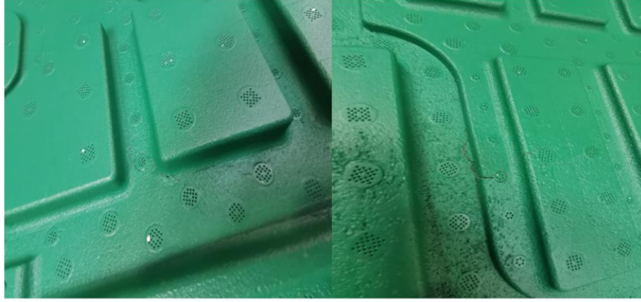
Fotoğraf 4.4. AGA İle Yapılan Kalıptaki Çatlaklar
