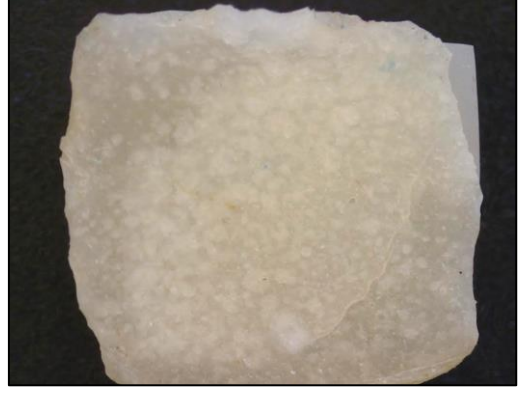
Şekil 4.11. Karışık tipteki kopmanın dentin yüzeyi görüntüsü. Şekil 4.12. Karışık tipteki kopmanın seramik yüzeyi görüntüsü.
