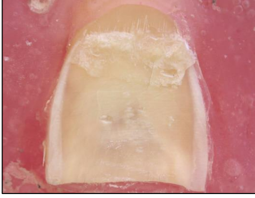
Şekil 4.11. Karışık tipteki kopmanın dentin yüzeyi görüntüsü. Şekil 4.12. Karışık tipteki kopmanın seramik yüzeyi görüntüsü.
