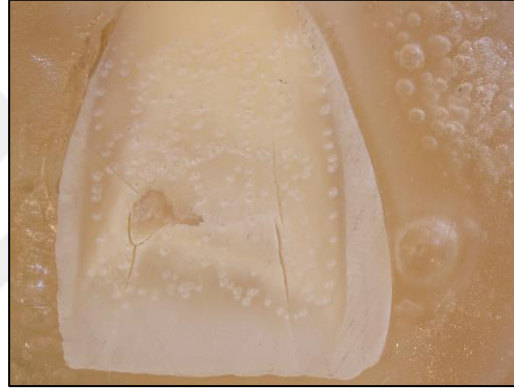
Şekil 4.13. ve Şekil 4.14. Dentin yüzeyindeki kohesiv tipteki kırılma.
