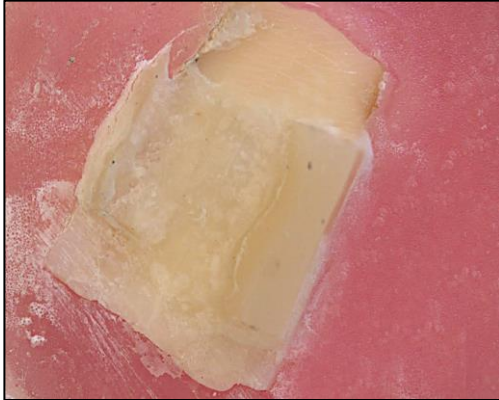
Şekil 4.15. ve Şekil 4.16. Seramikteki kohesiv kırılmanın dentin yüzeyindeki ve seramik yüzeyindeki görüntüsü.
