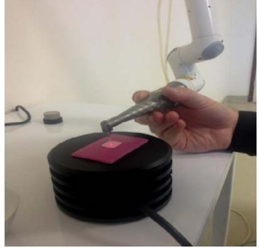
Resim 3.15. Power metre cihazı ile seramiklerin transmisyon değerlerinin ölçülmesi
