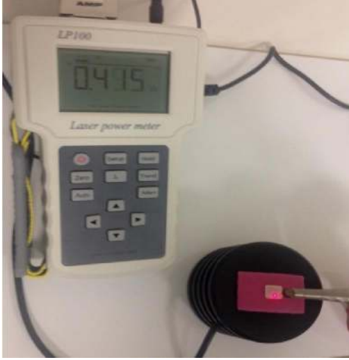
Resim 3.15. Power metre cihazı ile seramiklerin transmisyon değerlerinin ölçülmesi
