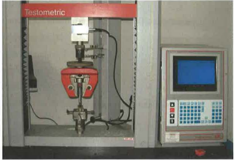
Resim 17: Sıyırma Kuvvetinin Uygulanmasında Kullanılan Test Cihazı ve Cihaza Bağlı Olan Bilgisayar.
