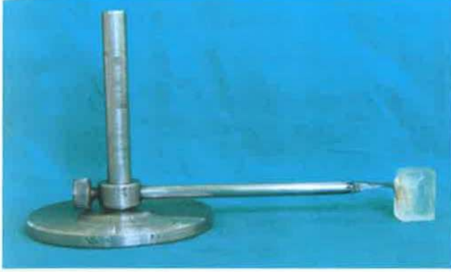
Resim 12: Braket Slotunun Yere Paralel Konumlandırılmasını Sağlayan Özel Düzenek ve Düzenek Yardımıyla Hazırlanmış Bir Örnek.
