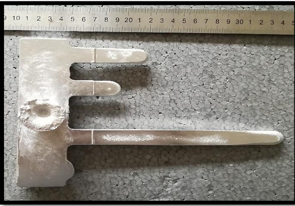
Şekil 16: Akıcılık Döküm Numuneleri a)İlavesiz b)%0,03 Er İlaveli c) %0,06 Er İlaveli d)%0,1 Er İlaveli
