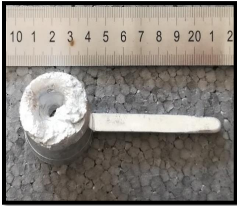
Şekil 16: Akıcılık Döküm Numuneleri a)İlavesiz b)%0,03 Er İlaveli c) %0,06 Er İlaveli d)%0,1 Er İlaveli
