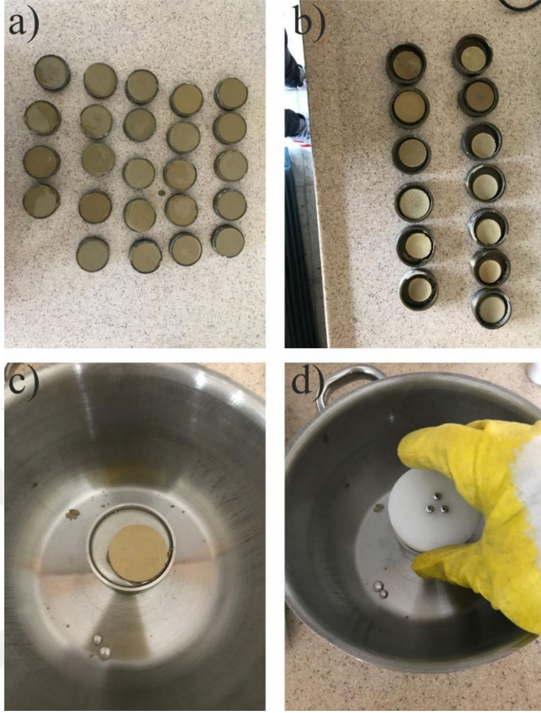
Resim 3.6 a) Numunenin hazırlanması b) Etüvde kurutulan numune c) Etüvden alınan numunenin cıva dolu kaba konulması d) Aparat yardımıyla cıvanın taşırılması
