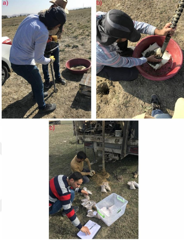
Resim 3.2 a) El burgusu ile numune alınması. b) Alınan numunenin bir kaptan toplanması c) Numunelerin poşetlenmesi ve deney föyüne kaydedilmesi.
