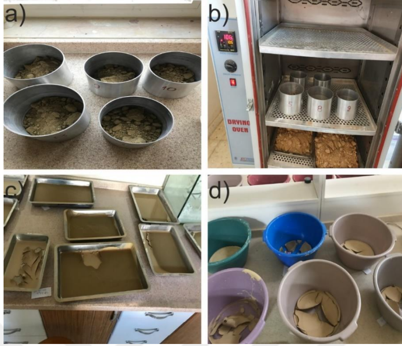
Resim 3.3 a) Numunelerin kaplara koyularak tartılması. b) Numunelerin etüve yerleştirilmesi. c) Etüvde kurutulan numunelerin laboratuvarda kurumaya bırakılması. d) Laboratuvar ortamında kuruyan numunelerin görseli.
