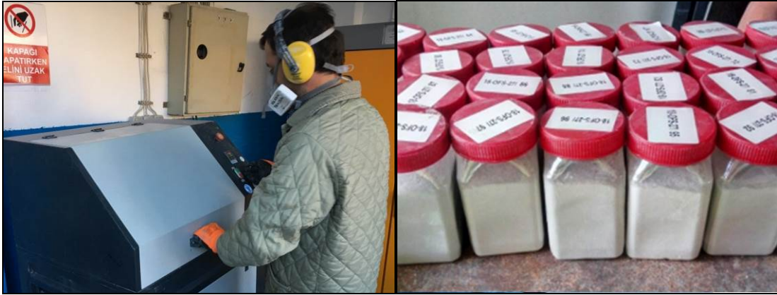
Şekil 3.9. Numunelerin öğütme işlemi
