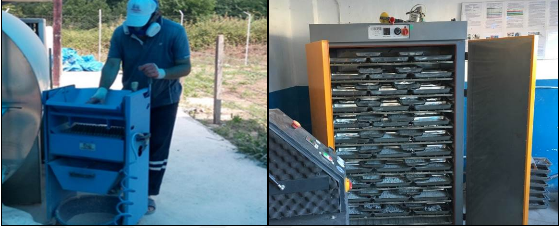
Şekil 3.8. Numunelerin çeyrekleme ve etüv işlemi
