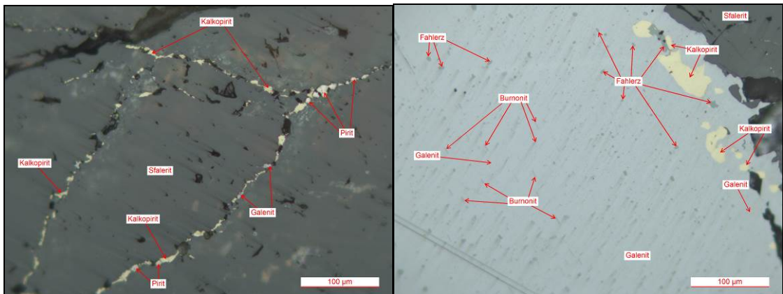
Şekil 4.30. Erenler alterasyon sahasından derlenen örneklerdeki cevher minerallerinin cevher mikroskopisi görüntüleri (Aer-33, 564.00-467493)
