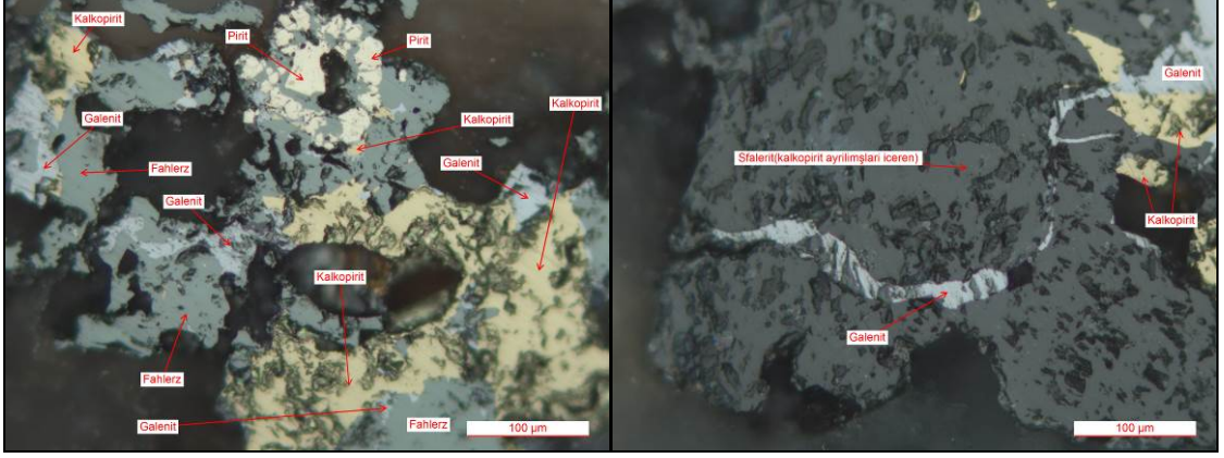
Şekil 4.24. Erenler alterasyon sahasından derlenen örneklerdeki cevher minerallerinin cevher mikroskopisi görüntüleri (Aer-32; 599.00-467487)
