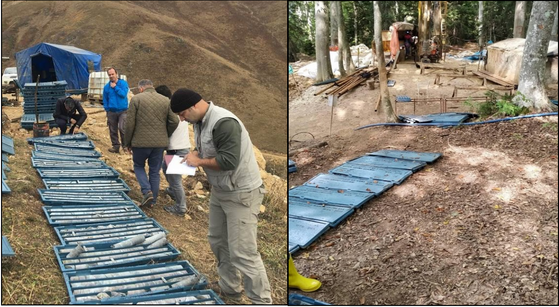
Şekil 3.1. Karotların arazideki ön determinasyonu
