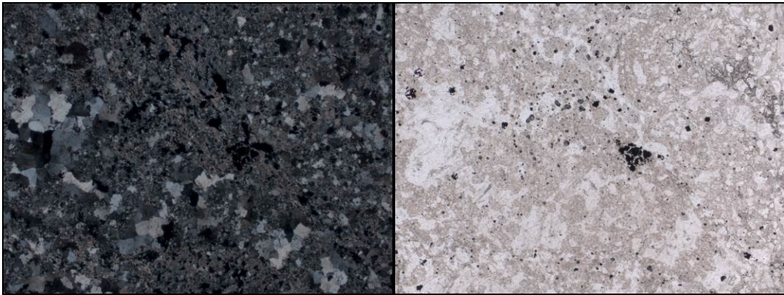
Şekil 4.17. Erenler alterasyon sahasından derlenen örneklerden yapılan ince kesitlerde gözlenen dasit örneğinin ince kesiti (417906-Aer-30, 590,00)
