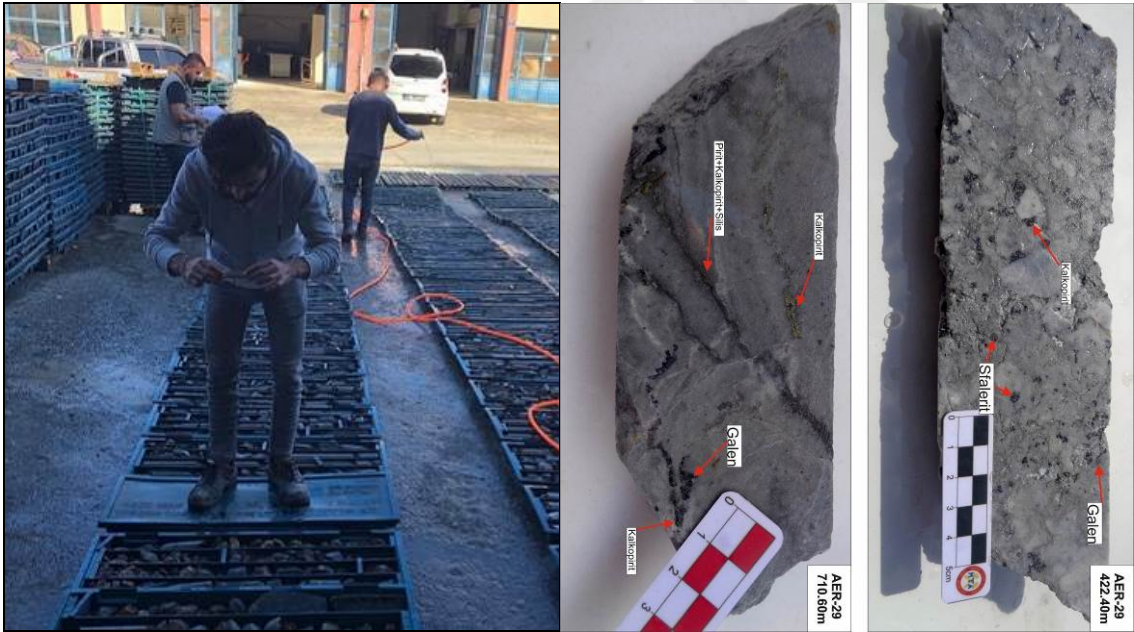
Şekil 3.4. Karotların fotoğraflanma işlemi
