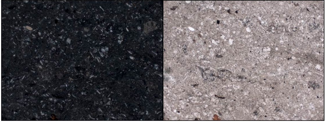
Şekil 4.21. Erenler alterasyon sahasından derlenen örneklerden yapılan ince kesitlerde gözlenen Tuf örneğinin ince kesiti (417900 Aer-30,261.00)
