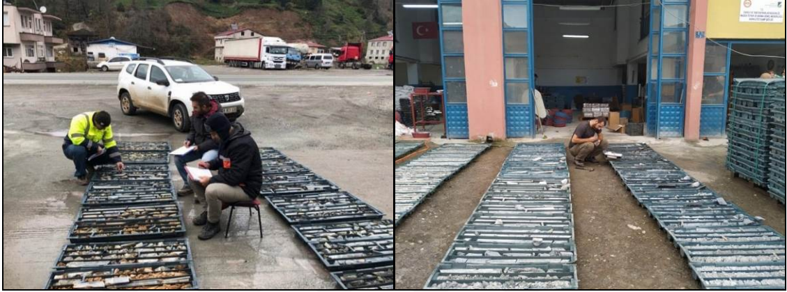
Şekil 3.5. Karotların detay determinasyonunun yapılması
