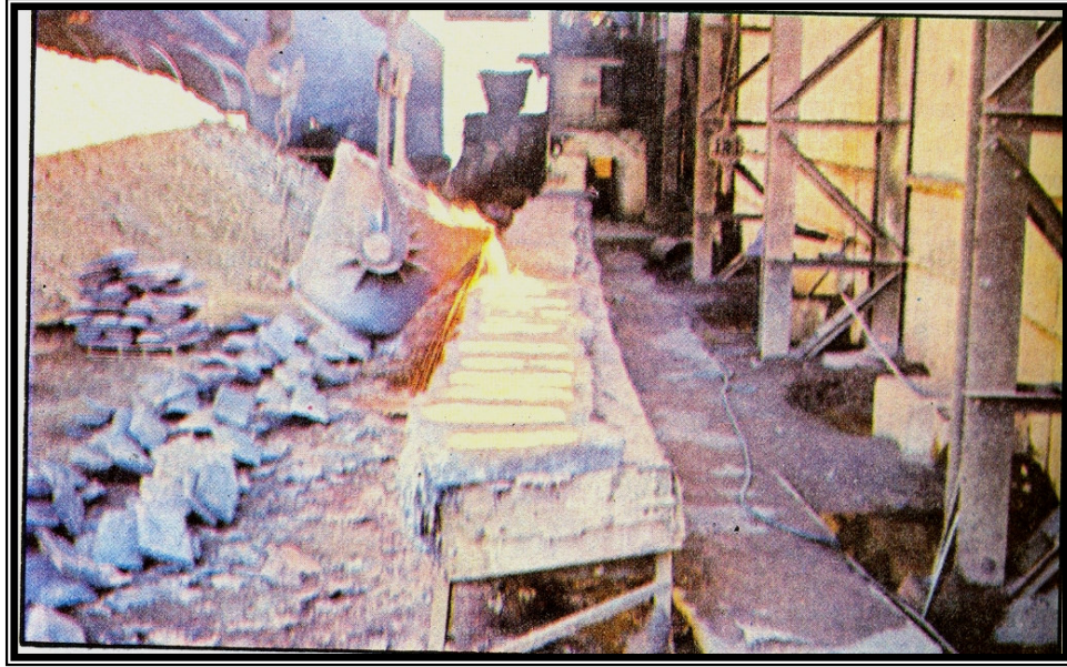
Resim 17 – Blister bakırın kalıplara dökülüşü ( Maden 1986 İlçe Yıllığı adlı eserden alınmıştır.)
