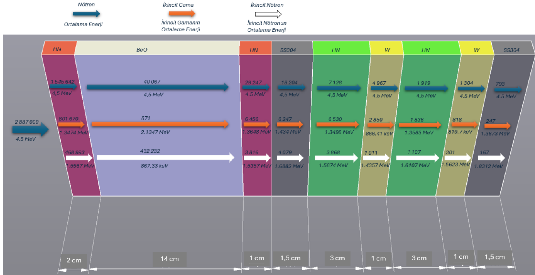
Şekil 4.9 Reaktörün 9 katmanlı önerilen haline 4,5 MeV enerjili 2 887 000 nötron gönderimi sonucu geçen, ikincil oluşan nötron ve ikincil oluşan gama. Kalınlık cm olarak alınmıştır.
