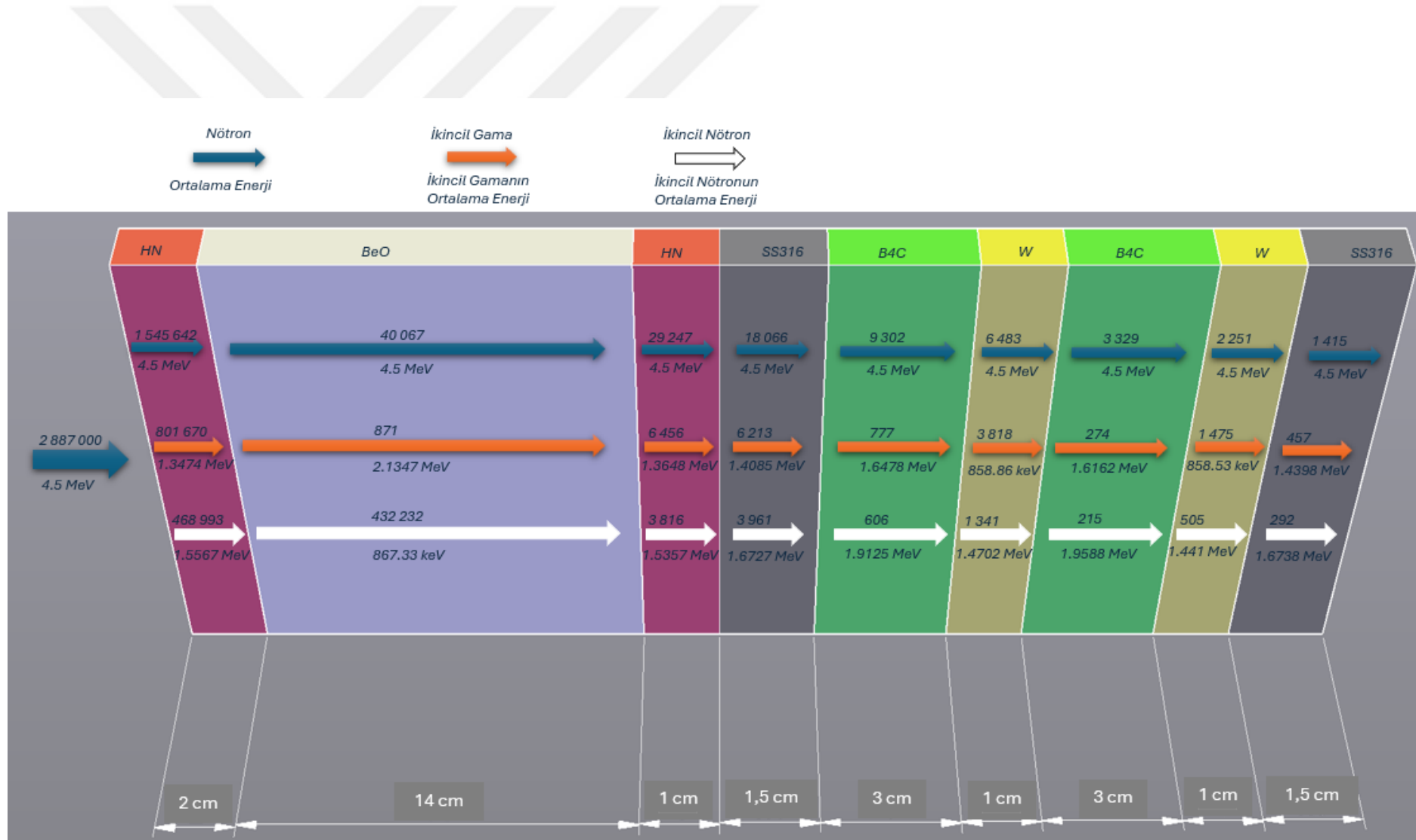
Şekil 4.8 Reaktörün 9 katmanlı asıl haline 4,5 MeV enerjili 2 887 000 nötron gönderimi sonucu geçen, ikincil oluşan nötron ve ikincil oluşan gamalar. Kalınlık cm olarak alınmıştır.
