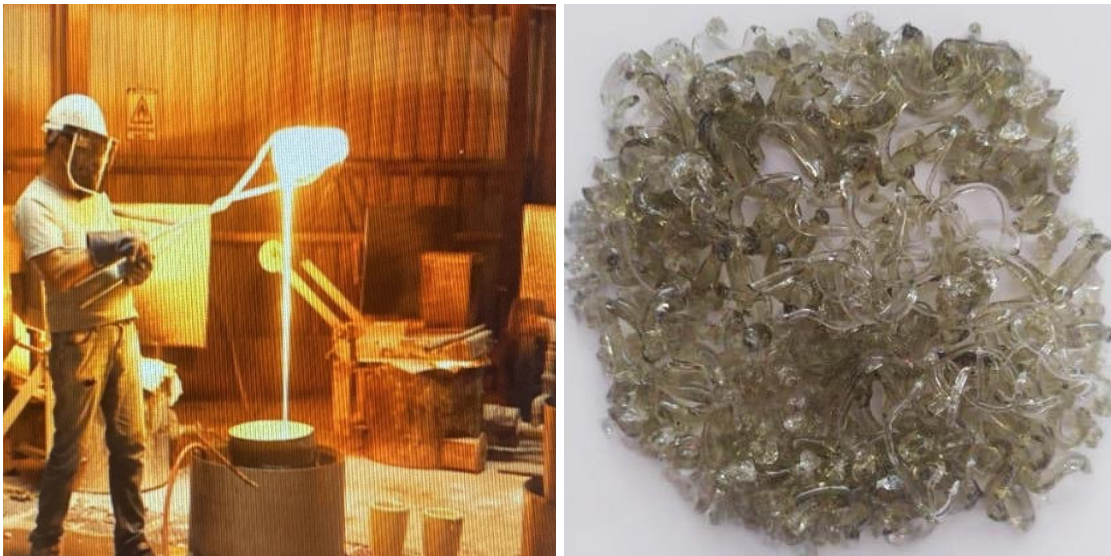
Resim 3.1 1500 °C’de ergitme işlemi (a) ve sonrası elde edilen fritin görüntüsü (b)
