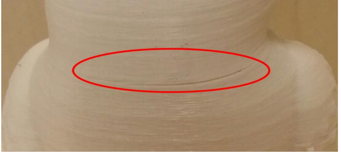
Şekil 1.15 : Katmanlar Arası Yapışmama Problemi
