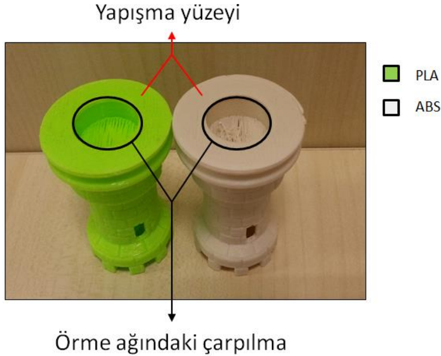
Şekil 1.13 : Yapışma Yüzeyi/Örme Lifleri
