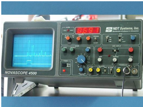
Resim 10. Ultrasonik cihaz ve çalışma şeması
