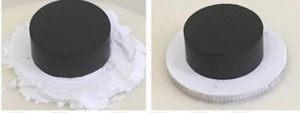
Şekil 20. Üretim esnasında örneklerin altına toz ve tablet şeklinde \text{Y}_2\text{O}_3 koyulması
