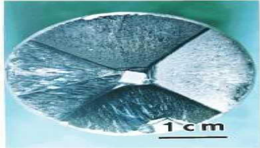
Şekil 12. “Merkezinde MgO kristali yerleşmiş iri taneleri barındıran süperiletken örneğinin resmi” (Kütük, 2008).
