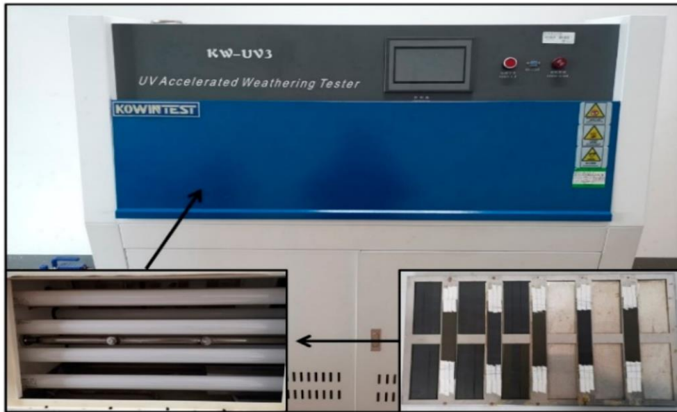
Şekil 2.11 Hızlandırılmış yaşlandırma kabini ve UV lambalar (Shi et al. 2022).
