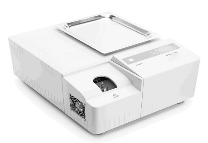
Şekil 3.7 Mettler Toledo Stare System DSC 823e Cihazı
