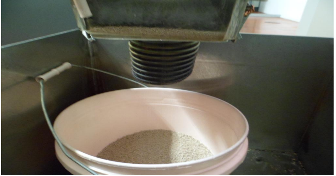
Şekil 4.11 Pelletizer’da kesilerek elde edilen masterbatch granülleri
