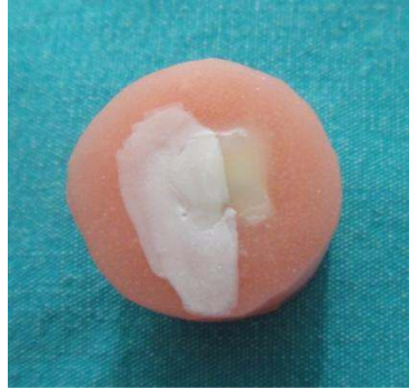
Resim 5: Kontrol yüzeyi olarak planlanan yüzeye çift kat cila sürülmüş bir diş örneđi
