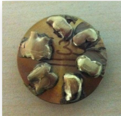
Resim 8: Mine örneklerinin altın kaplanmış görüntüleri
