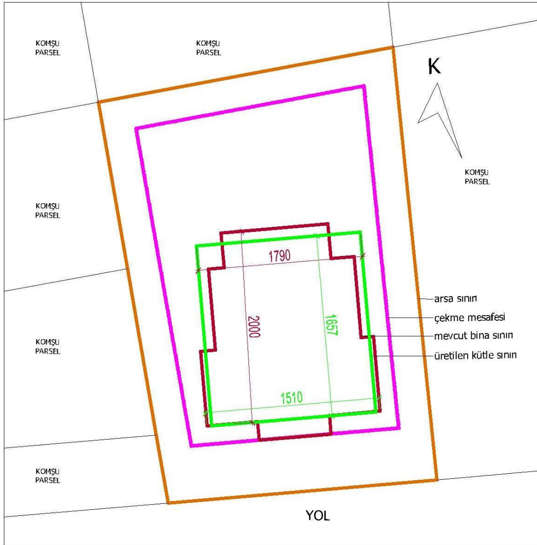
Şekil 4.3. Mevcut binanın planı ile optimize edilmiş/üretilen binanın taban oturum alan farkı
