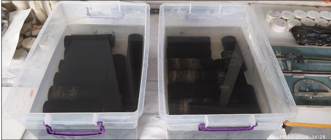
Şekil 3.14. Kömür karotlarının deney için su dolu kaplarda muhafaza edilmesi
