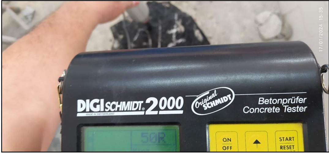
Şekil 3.8. Laboratuvarda kömür ve tavan taşı numunelerinde kullanılan Schmidt çekici fotoğrafı
