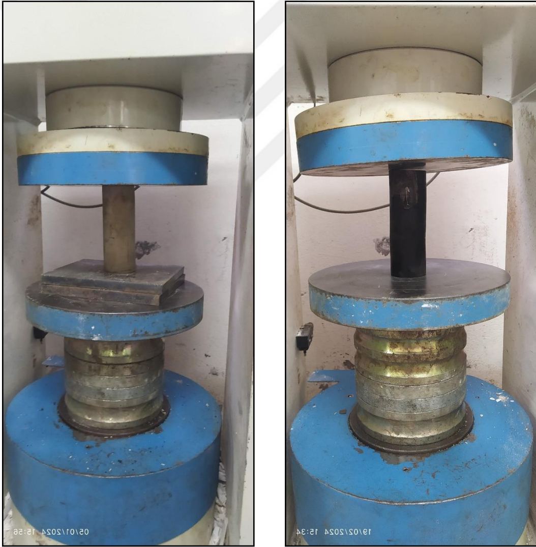
Şekil 3.13. Yük hücresinde tavan taşı (marn) ve kömür karotlarına uygulanan tek eksenli basınç deneyi
