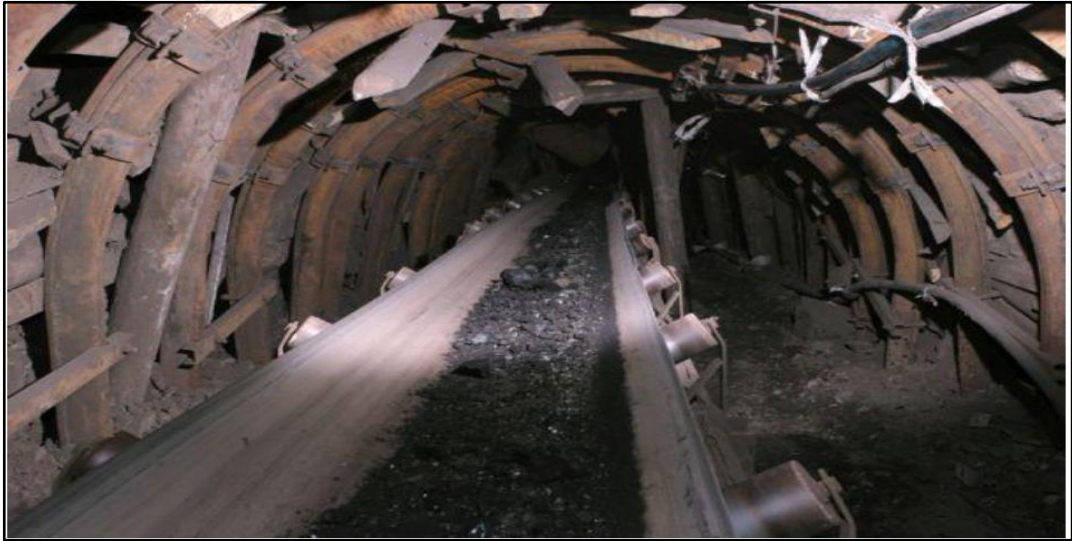
Şekil 4.7. Pano taban yollarında planlanan TH- geçme esnek demir tahkimata dönüşümü
