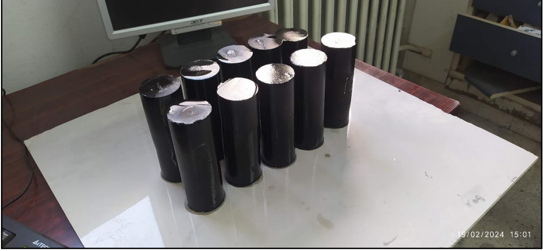
Şekil 3.9. Tek eksenli basınç deneyi için hazırlanan kömür numunelerine ait karotlar
