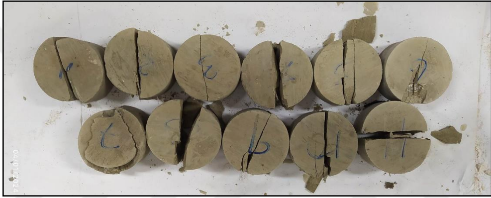
Şekil 4.29. Üçpınar tavan taşı (marn) için dolaylı çekme deneyinde kırılmış numuneler ait görseller
