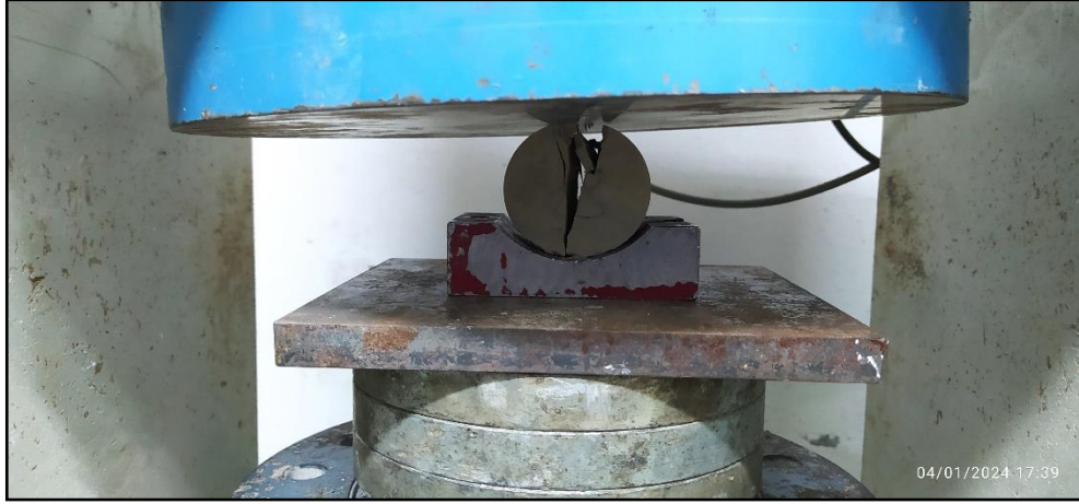
Şekil 4.28. Üçpınar tavan taşı (marn) için dolaylı çekme (brazilian) deneyine ait görseller
