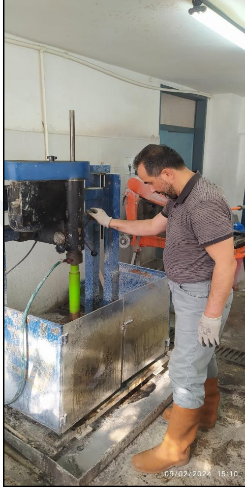
Şekil 3.4. Laboratuvarda blok numunelerden karot alınması ve hidrolik pres test ölçüm makinası
