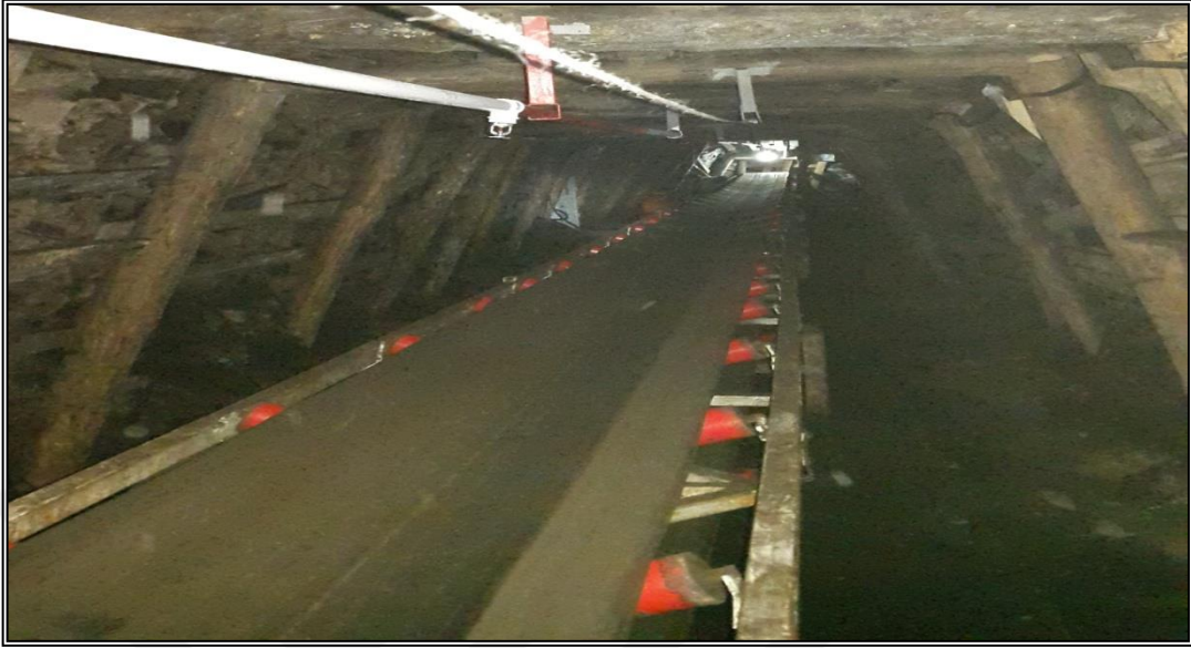
Şekil 4.12. Ocak içindeki ana nakliyat yolu üzerinde sprinker olan bant konveyör nakliyatı
