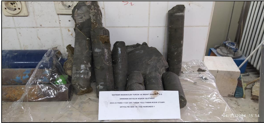
Şekil 3.7. Laboratuvarda karot alınan blok taban taşı serpantin numunelerine ait fotoğraf
