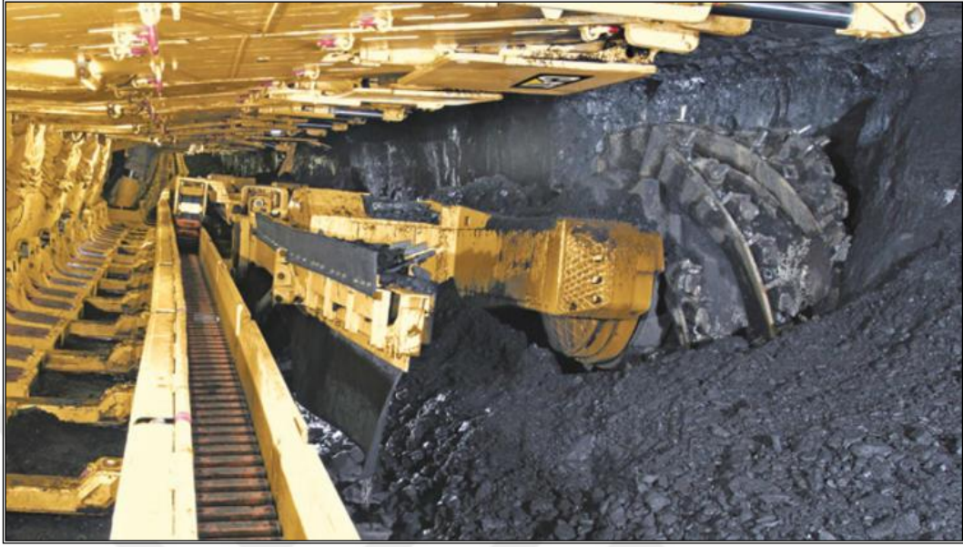
Şekil 2.1. Ayak kazı Arının da Direksiz cephe arın bölgesinin tahkimi (data:image/jpeg;base64)
