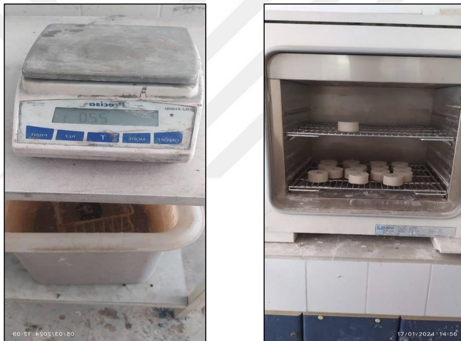
Şekil 3.31. Yoğunluk Birim Hacim Ağırlık deneyi için kömür ve marn karotlarının havada, su içinde ve 105°C fırında kurutularak hassas terazide tekrar tartılması
