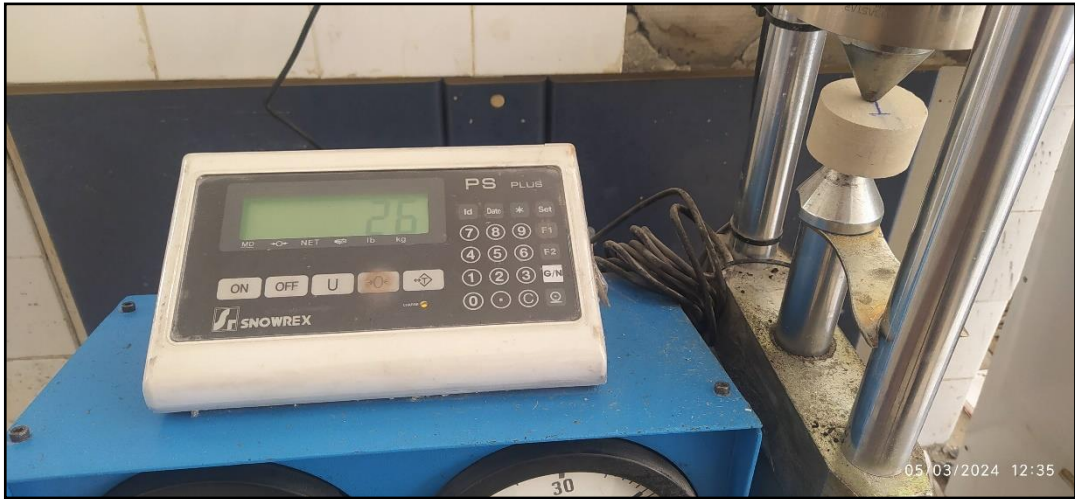
Şekil 4.30. Üçpınar tavan taşı (marn) için nokta yükü dayanım indeksi deneyine ait fotoğraf
