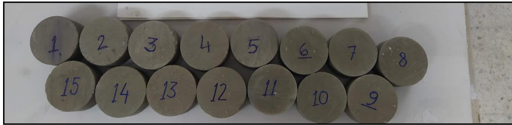
Şekil 3.15. Brazilian deneyi için hazırlanan tavan taşı marn numune karotları (54x30 mm boyutlarında)
