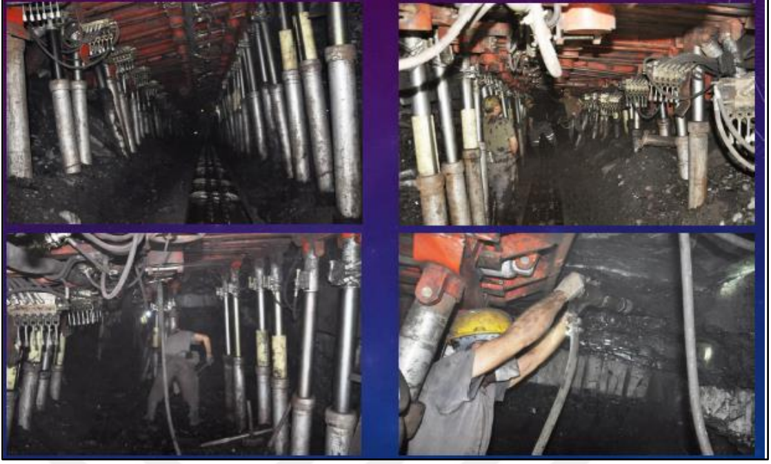
Şekil 5.2. Yarı mekanize tahkimat sisteminin uzun ayak üretim yönteminde (0-40°) uygulama tekniği
