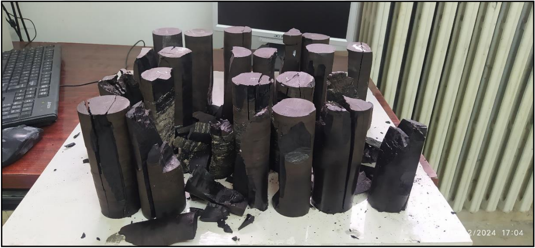
Şekil 3.10. Tek eksenli basınç deneyinde kırılan kömür numunelerine ait karotlar
