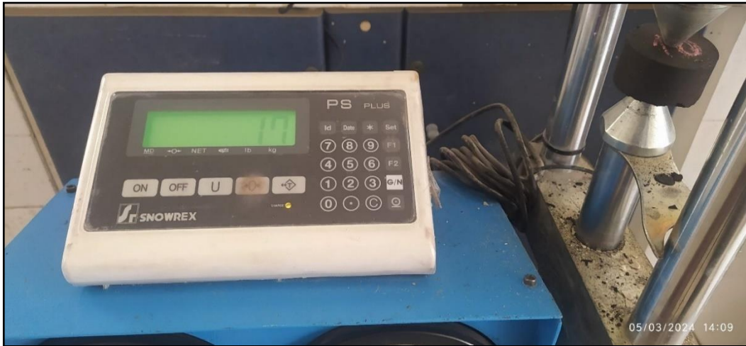
Şekil 4.23. Üçpınar kömürü için nokta yükü dayanım indeksi deneyine ait fotoğraf
