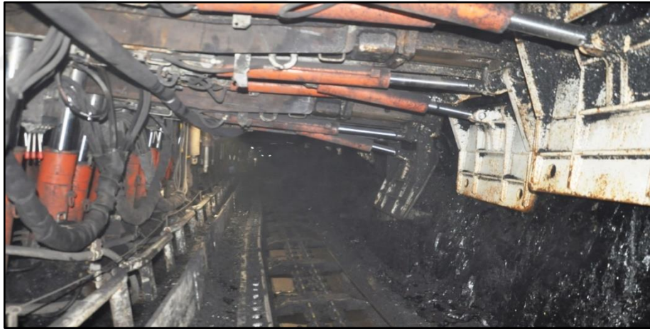
Şekil 4.37. Ayakta arın bölgesinde direksiz alan teşkili ve ayna kapağı (flipper) donanımı
