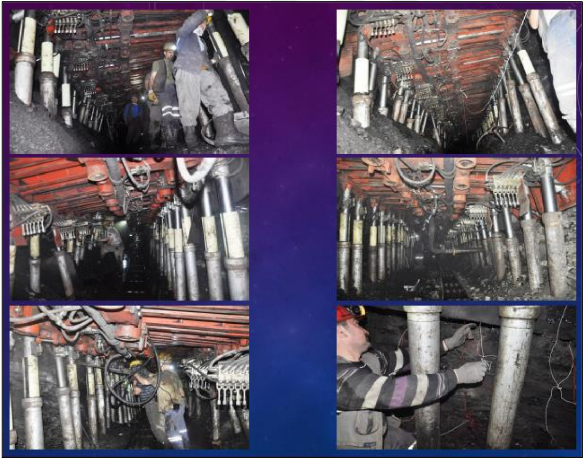
Şekil 5.3. Yarı mekanize tahkimat sisteminin uzun ayak üretim yönteminde (0-40°) uygulama tekniği
