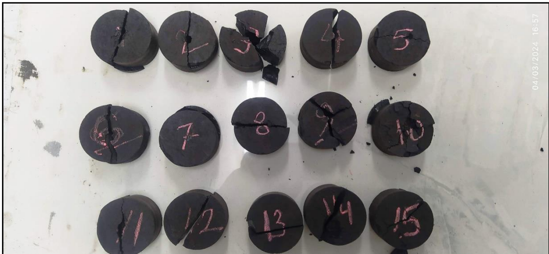
Şekil 3.26. Kömür karotlarının eksenel nokta yükü dayanım indeksi deneyinde kırılması
