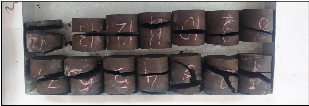
Şekil 3.28. Kömür karotlarının çapsal nokta yükü dayanım indeksi deneyinde kırılması
