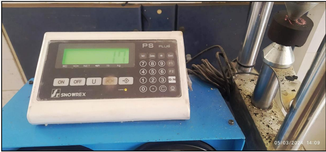
Şekil 3.25. Kömür karotlarının eksenel nokta yükü dayanım indeksi deneyi uygulaması
