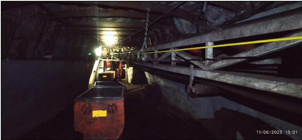
Şekil 4.43. Mekanize sistem ana nakliyat yolunda raylı sistem ve band konveyör nakliyat fotoğrafı
