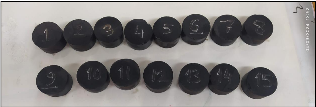
Şekil 3.18. Brazilian deneyi için hazırlanan kömür numuneleri
