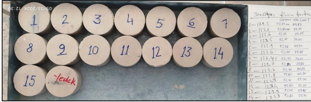
Şekil 3.21. Nokta yükü dayanım indeksi deneyi için hazırlanan tavan taşı (marn) karotları
