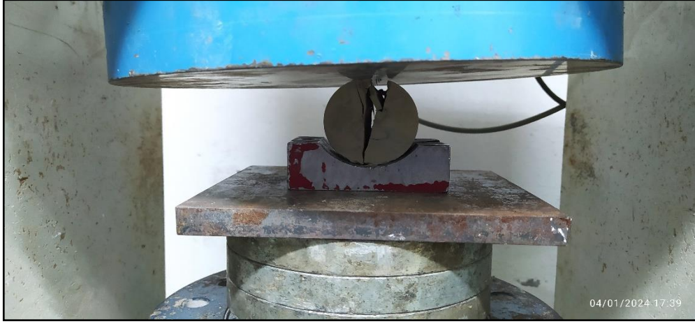
Şekil 3.16. T Brazilian deneyinde tavan taşı (marn) karotlarında gerçekleştirildiği fotoğraf
