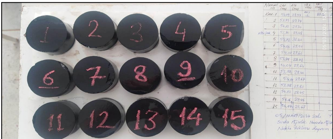
Şekil 3.29. Kömür karotlarının Yoğunluk Ağırlık Hacim deneyine hazırlanması
