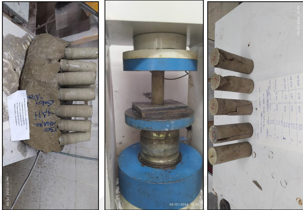
Şekil 4.26. Üçpınar tavan taşı (marn) için karot alınmış blok, tek eksenli basınç deneylerine ait görseller
