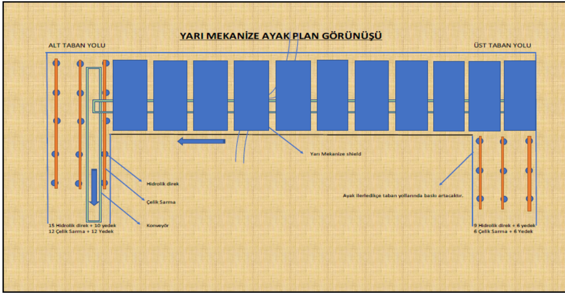
Şekil 5.4. Yarı mekanize tahkimat sisteminin uzun ayak üretim yönteminde plan görünüşü
