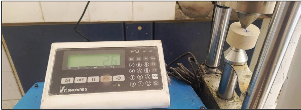
Şekil 3.22. Tavan taşı-marn karotlarının nokta yükü dayanım indeksi deneyi uygulaması
