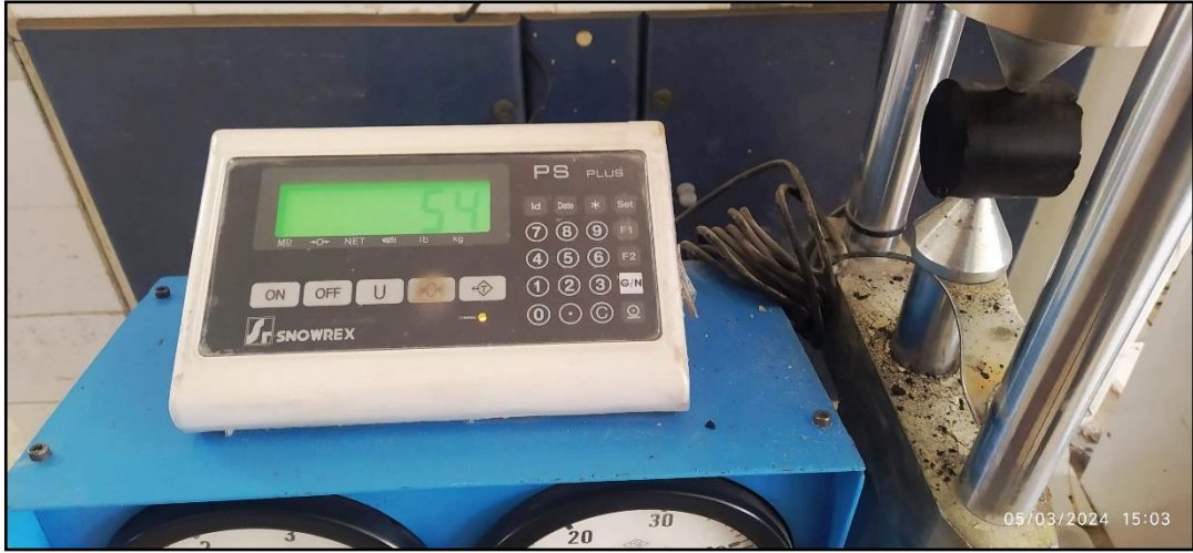
Şekil 3.27. Kömür karotlarının çapsal nokta yükü dayanım indeksi deneyi uygulaması
