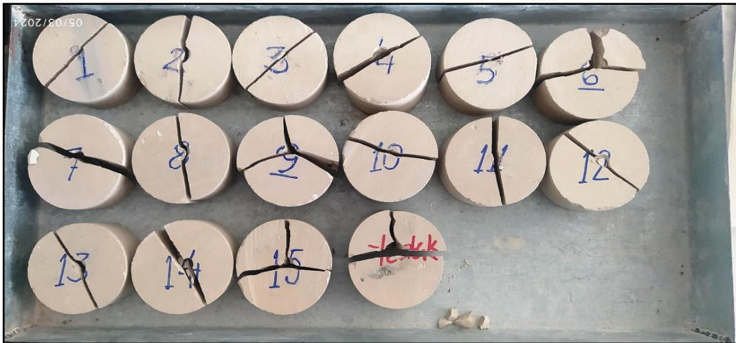
Şekil 3.23. Tavan taşı-marn karotlarının nokta yükü dayanım indeksi deneyinde kırılması
