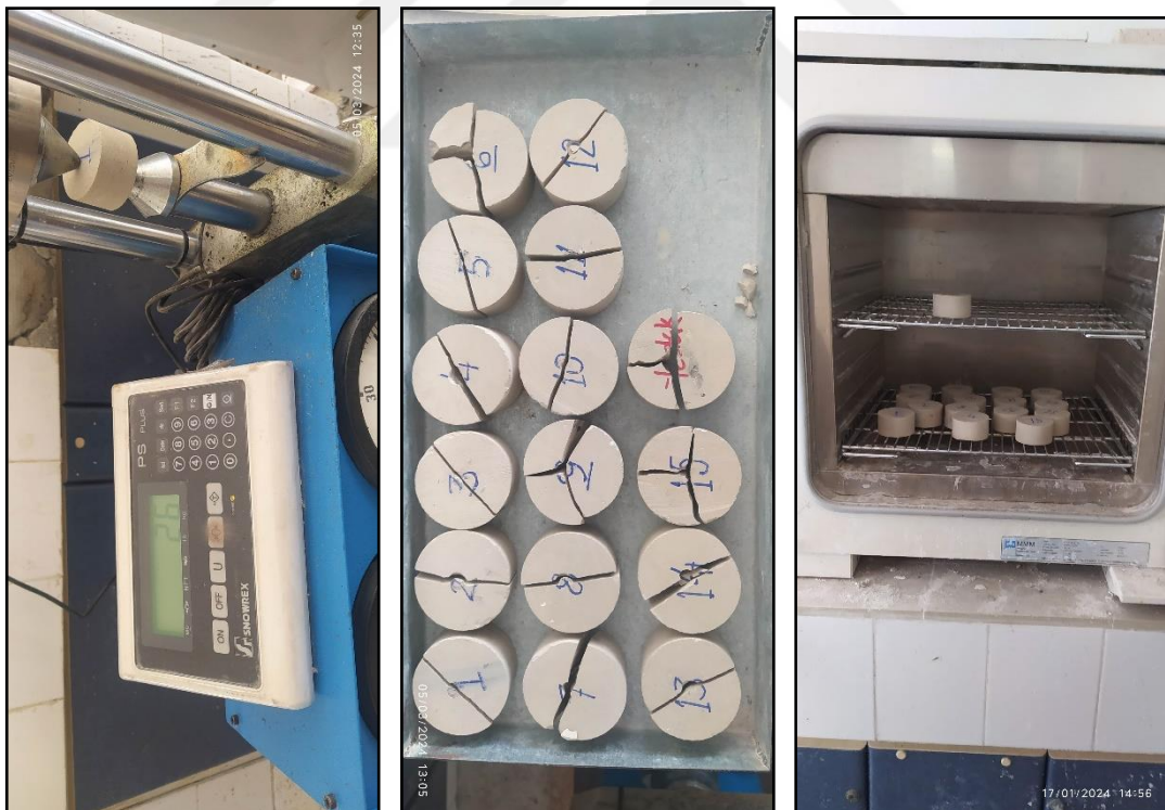
Şekil 4.27. Üçpınar tavan taşı (marn) için nokta yükü dayanım deneylerine ve etüv fırına ait görseller
