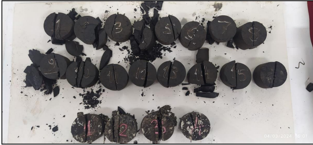
Şekil 3.20. Brazilian deneyi uygulanarak kırılan kömür numuneleri
