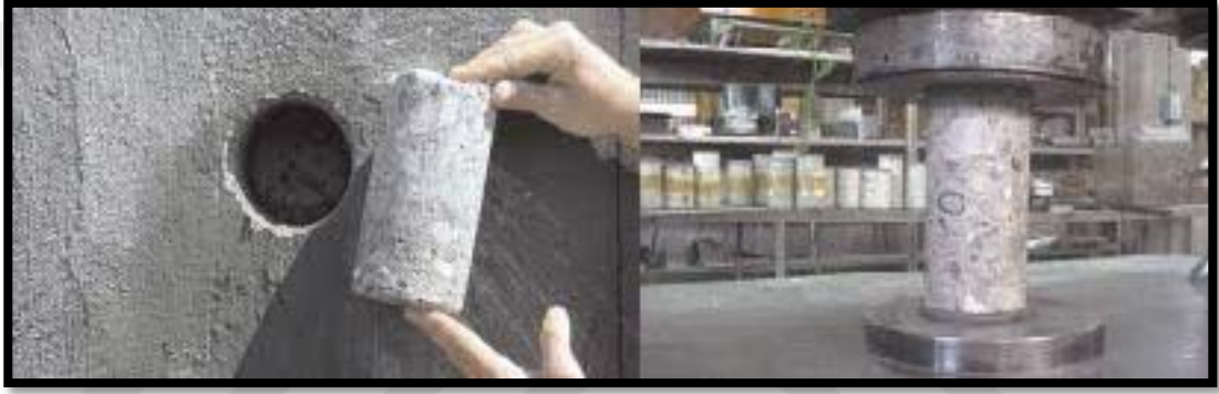
Şekil 3.2. Beton karot örneği ve başlıkları hazırlanmış karot örneğinin serbest dayanım testi sırasındaki görünümü (İlhan, 2003).
