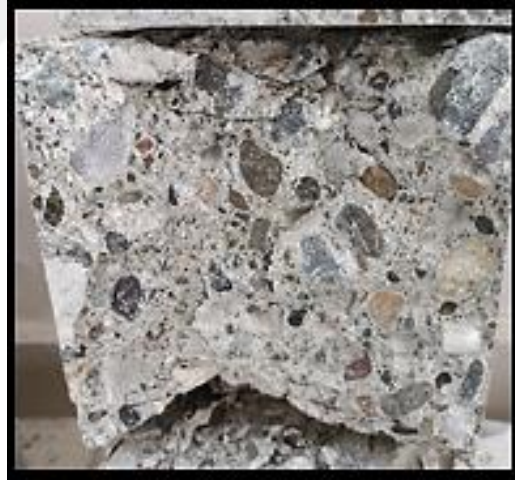
Şekil 5.4. Hazırlanan kübik numunelerde agrega sıyrılması ve agreganın kırılması.
