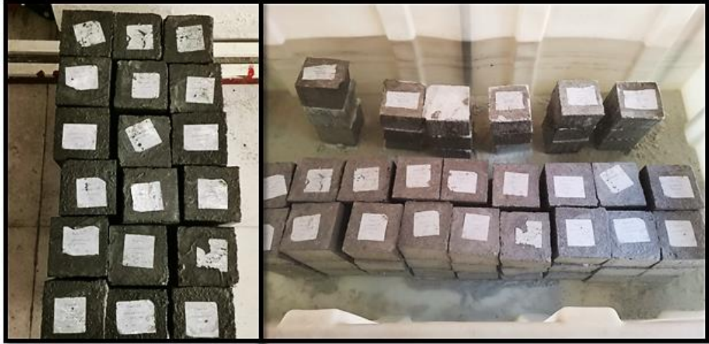
Şekil 4.6. Hazırlanmış kübik numunelerin deney öncesi bekletilmesi.
