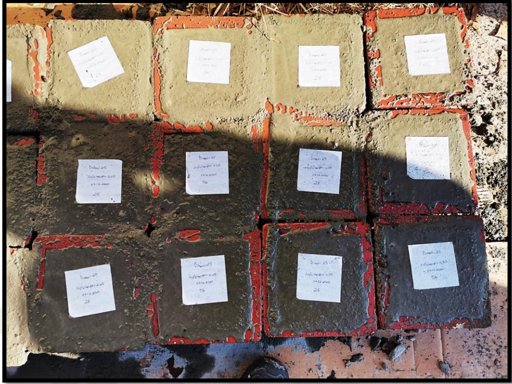
Şekil 4.5. Kübik numunelerin hazırlanması sırasında kalıplara dökülüp bekletilmesi.
