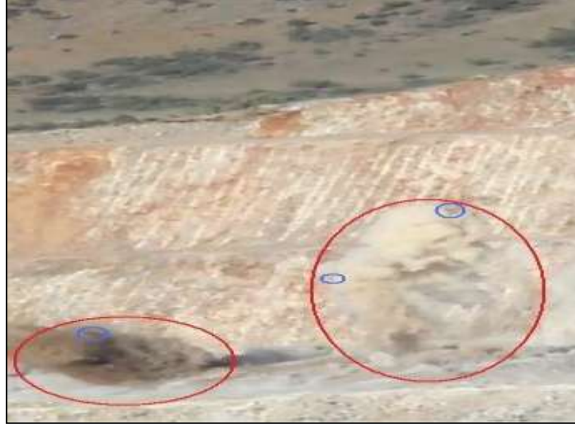
Şekil 4.6 Sahada yapılan patlatmalar sırasında taş savrulması (Bilgin, 2010).
