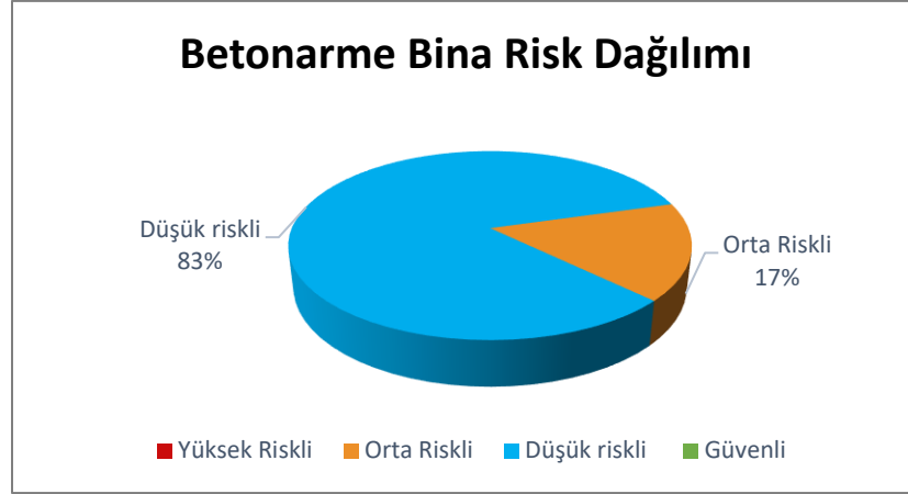
Şekil 5.46. Çarşı Mahallesi betonarme bina risk dağılımı
