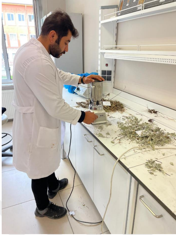
Şekil 3.9. Kurutulan örneklerin blenderda öğütülerek toz haline getirilmesi.
