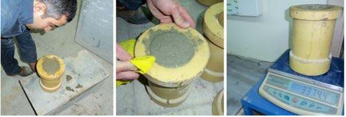
Şekil 3.12. Taze beton birim kütlesinin belirlenmesi
