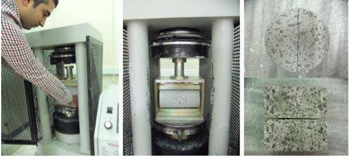
Şekil 3.17. Yarmada Çekme dayanımı deneyinin yapılışı ve numunesi
