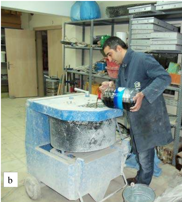
Şekil 3.7. Beton örneklerinin üretimi; a) Malzemelerin kuru karıştırılması, b) Karışıma akışkanlaştırıcı katkılı su ilavesi
