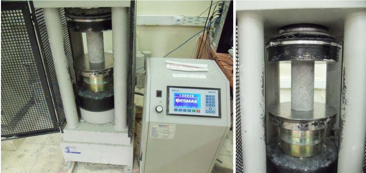
Şekil 3.14. Tek eksenli tahribatlı yöntemle basınç dayanımının belirlenmesi
