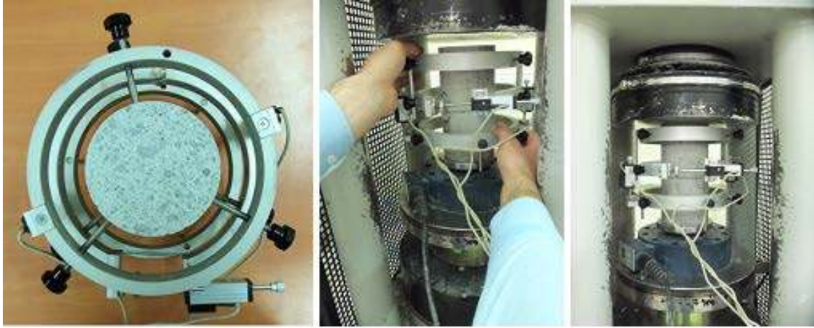
Şekil 3.16. Beton numunelerin elastisite modülü deneyinin yapılışı
