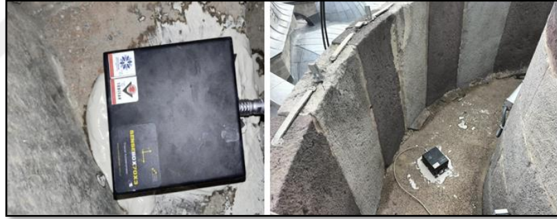
Şekil 4.19. Lala Mustafa Paşa Camii minaresi ivmeölçer sabitleme işlemleri
