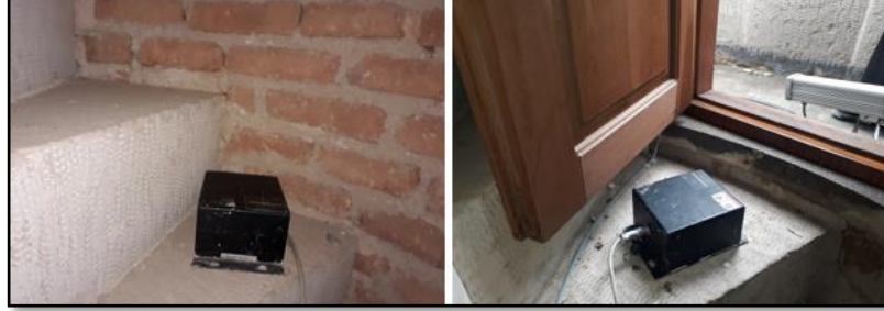
Şekil 4.105. Hacı Cuma Camii minaresi ivmeölçer sabitleme işlemi
