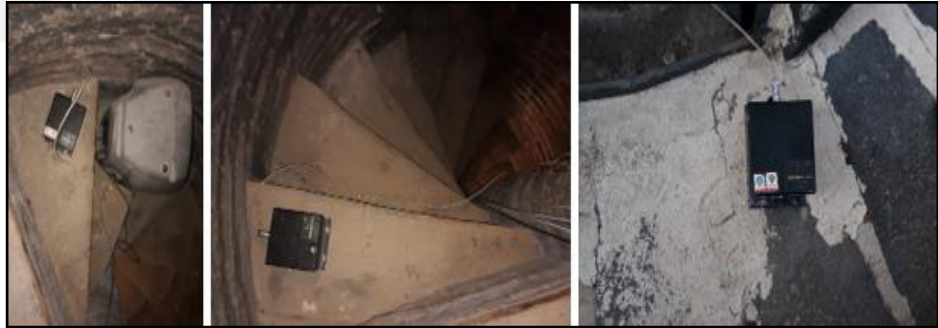
Şekil 4.33. Ulu Cami minaresi ivmeölçer sabitleme işlemi
