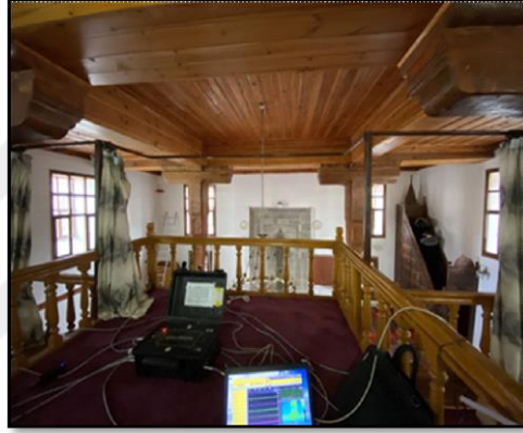
Şekil 4.82. Yeğenağa Camii minaresi veri toplama sistemi (Özdoğan 2024)
