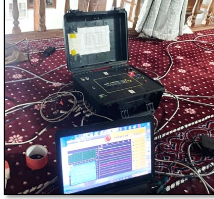
Şekil 4.70. Aşağı Hasan-ı Basri Taş Camii minaresi veri toplama sistemi
