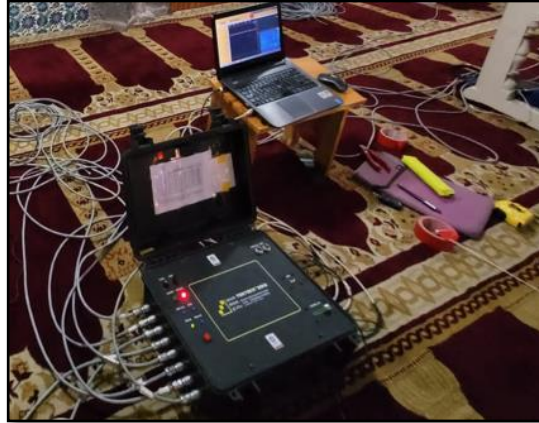
Şekil 4.8. Pervizoğlu Camii minaresi OMA veri toplama sistemi
