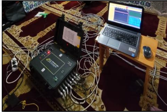
Şekil 3.49. OMA uygulamasında kullanılan dinamik veri toplama sistemi
