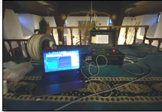
Şekil 4.94. Kadana Camii minaresi OMA çalışması veri toplama sistemi
