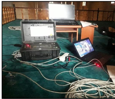
Şekil 4.34. Ulu Cami minaresi OMA çalışması veri toplama sistemi
