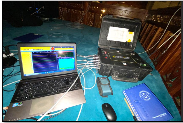
Şekil 4.20. Lala Mustafa Paşa Camii minaresi OMA çalışması veri toplama sistemi
