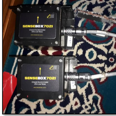
Şekil 3.48. OMA yönteminde tepki titreşimi kayıtları için kullanılan hassas ivmeölçerler
