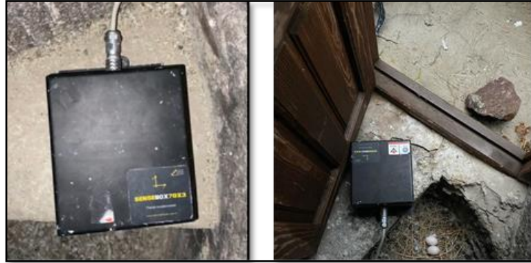
Şekil 4.69. Aşağı Hasan-ı Basri Taş Camii minaresi ivmeölçer sabitleme işlemi
