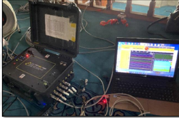
Şekil 4.58. Yukarı Habip Efendi Camii minaresi veri toplama sistemi
