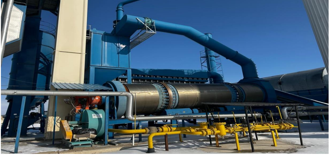
Şekil 8. Agregada kurutma (dryer) tamburu ve brülör sistemi – Erzurum asfalt sahası (Saha fotoğrafı, 2025)
