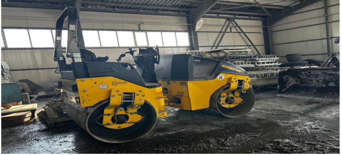
Şekil 12. Asfalt sıkıştırma işleminde kullanılan silindir makinesi (Saha fotoğrafı, 2025)
