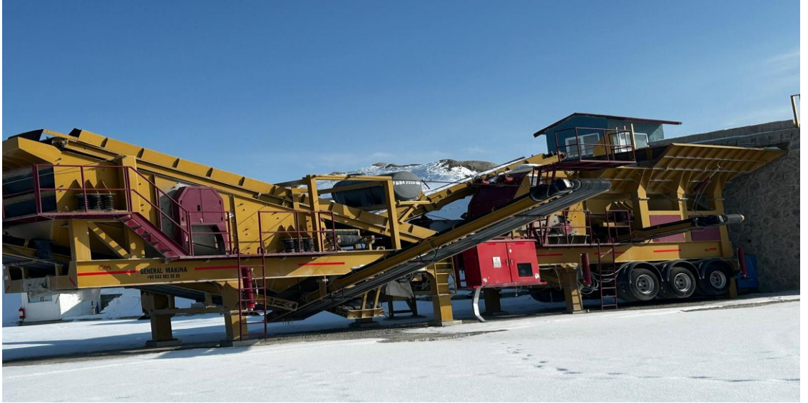
Şekil 7. Kırma-eleme ve konveyör bant sisteminden oluşan besleme ünitesi – Erzurum asfalt sahası (Saha fotoğrafı, 2025)
