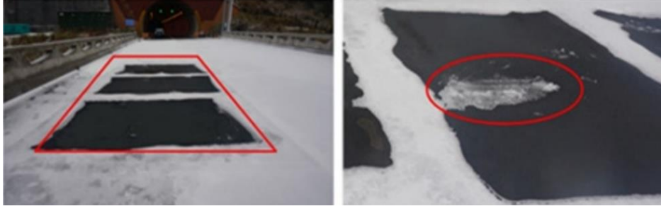
Görsel 10: İletken Asfalt Kaplaması ile Kar ve Buz Eritme İşlemi
