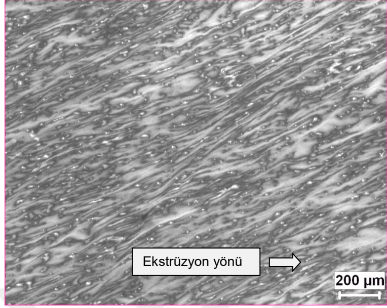
Şekil 33. Al 20 Zn-2Cu alaşımasının Rota-B C ile 2 paso EKAЕ işlemi uygulanmış durumdaki içyapısı (A yüzeyi)
