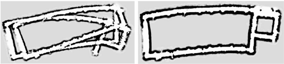
Şekil 3.4 (a) Ham sonar algılayıcı verisi kullanan işgal edilen alanlar algoritmasının sonucu.
