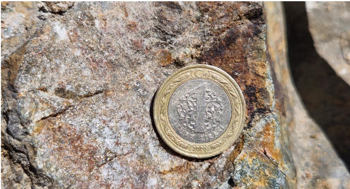
Şekil 4.26. Esendal köy merkezinde dere yatağı boyunca gözlenen birimlerden alınan yoğun pirit-kalkopirit içeren örnek.
