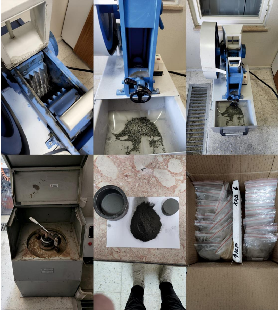
Şekil 3.5. Numunelerin çeneli kırıcı ve halkalı değirmen kullanılarak öğütülüp paketlenmesi.
