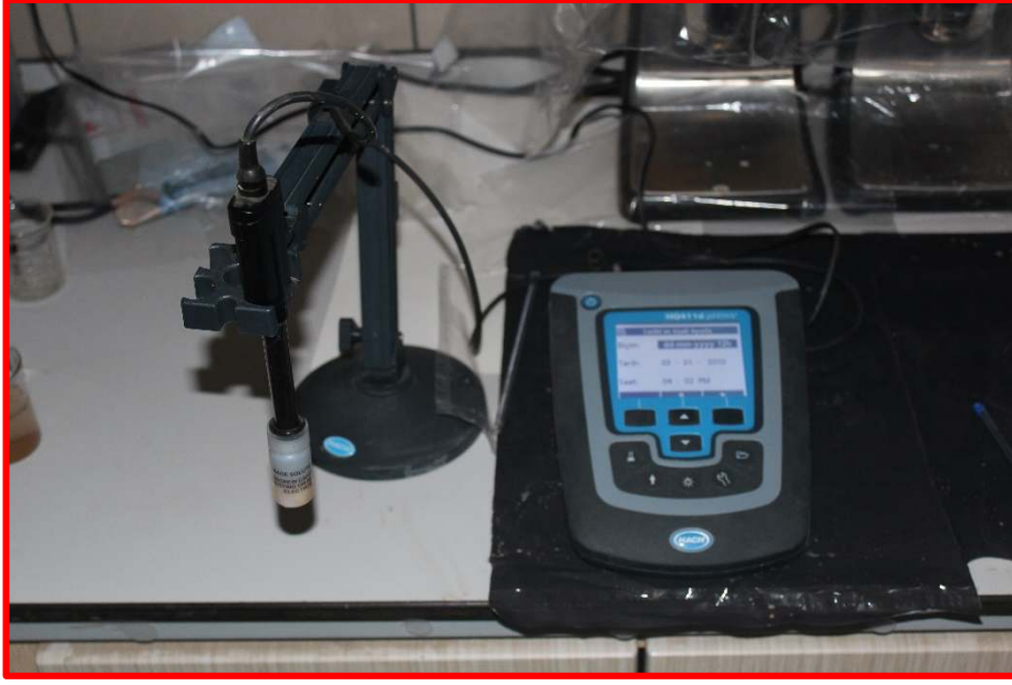
Şekil 15. pH analizinde kullanılan cihaz
