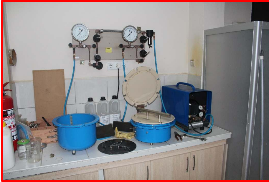
Şekil 17. Toprakların tarla kapasitesi ve solma noktası tayininde kullanılan cihaz
