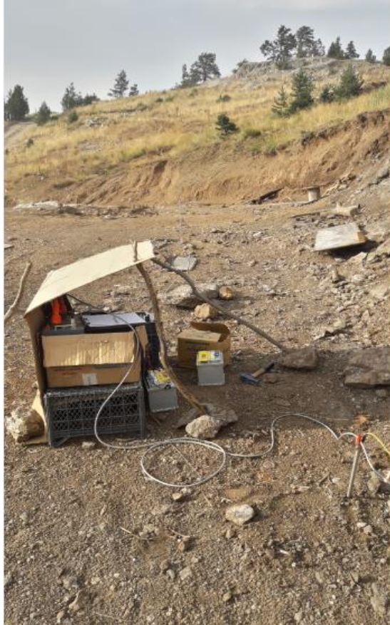
Şekil 15. İnceleme alanı sınırları içerisindeki yapılmış EÖT ölçüm arazi çalışmaları
