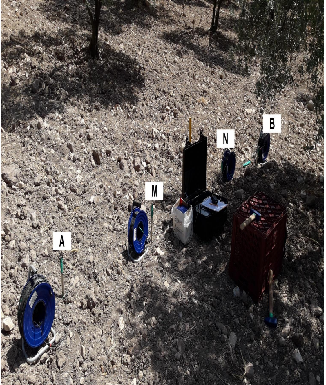
Şekil 7. Schlumberger ölçüm tekniği arazi dizilimi gösterimi
