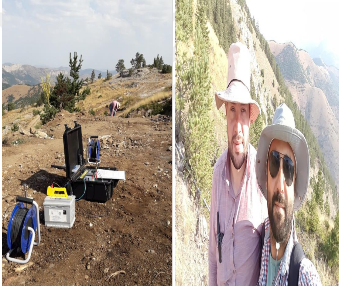
Şekil 17.İnceleme alanı sınırları içerisindeki 4 elektrot öz direnç cihazı kullanılarak yapılmış des ölçüm arazi çalışmaları
