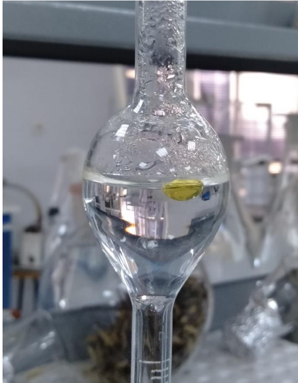
Görsel 3.3. Kimyon meyve uçucu yağının Clevenger apareyinde toplanmış hali Foto: (S. Candar.)
